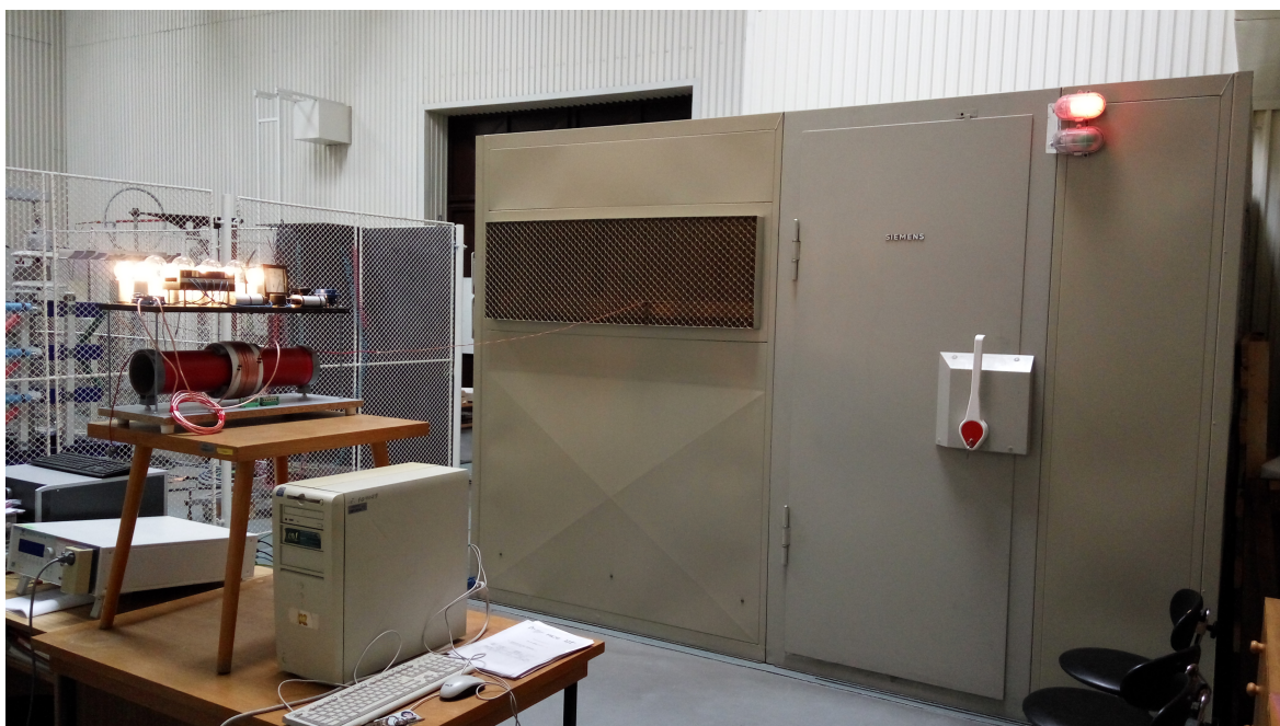
Obr. 3.39 Příjímací část systému SWRL je umístěná vně stínicí komory
