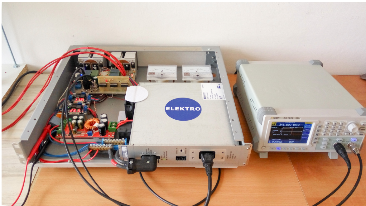
Obr. 3.10 Systém pro napájení SWRL: DDS generátor signálů, zdroj SS napětí 27V 1200W, boost (step-up) konvertor do 83,5V, H-můstkový střídač do 600 kHz, analogový ampérmetr a voltmetr
