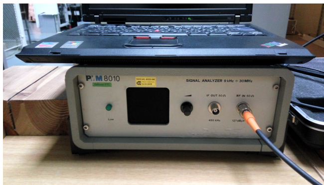
Obr. 3.43 Měření elektrické složky pole pomocí přístroje PMM8010
