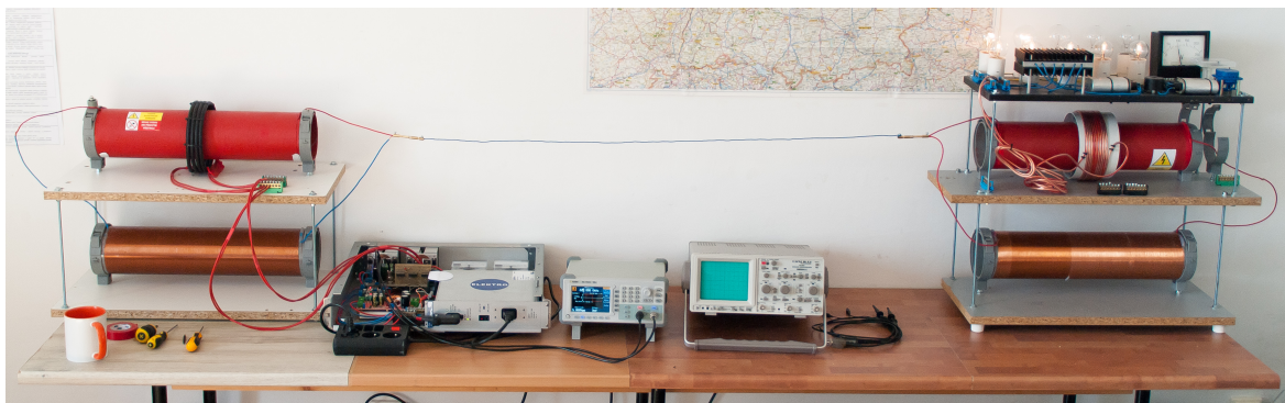
Obr. 3.28 Pohled na měřicí pracoviště při měření efektivnosti přenosu
