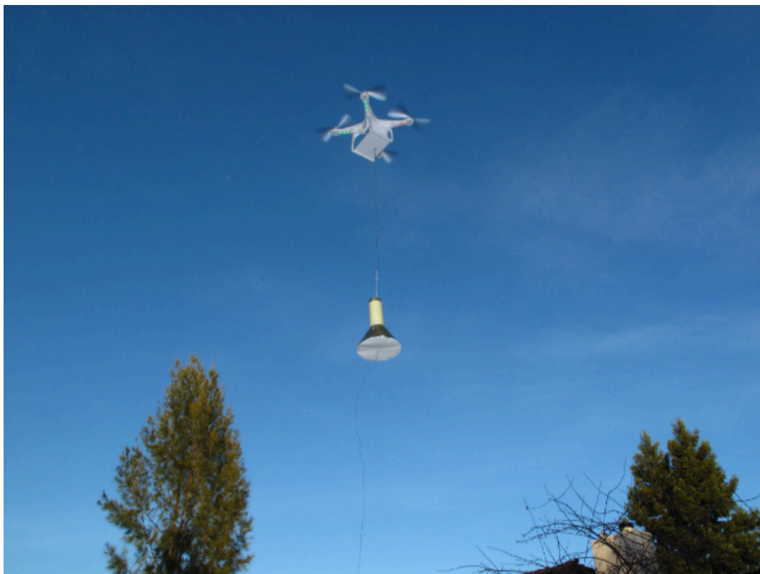
Obr. 3.2 Napájení kvadroptéry s vysílací anténou pomocí povrchových vln [30]
