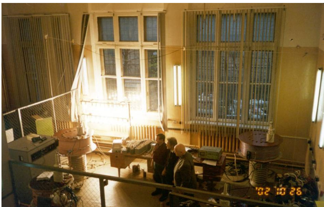
Obr. 2.9 Testování jednovodičového rezonančního systému o výkonu 20 kW [43]
