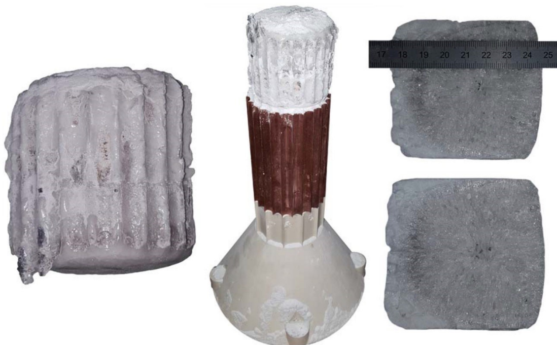
Obrázek č.5: Ingot korundu; studený kelímek bez chl. segmentů; řez ingotem
