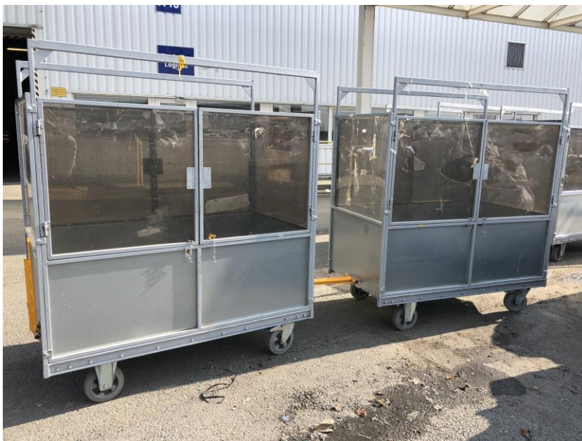
Obr. 5 Vagónky určené k přepravě menších odpadů [Zdroj: vlastní]
