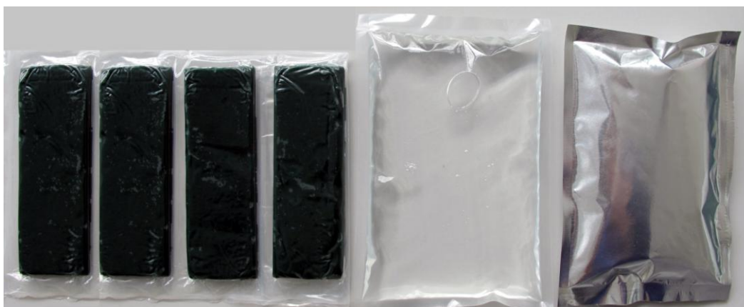
Obr. 18 – Pěnové PCM ve fólii, roztok PCM v průhledném a hliníkovém obalu [15]
