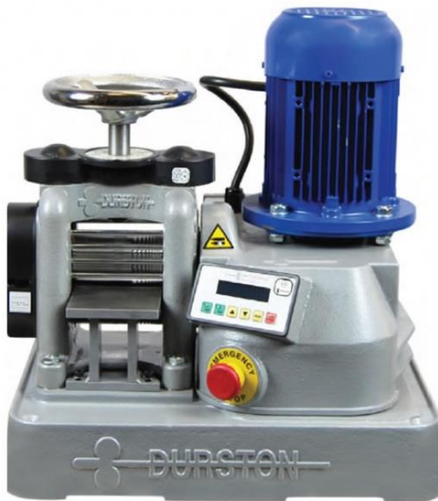
Obr. 2.3 – Válcovací stolice s elektrickým pohonem [5]
