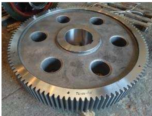
Obr. 40 – Svařované dvoudiskové ozubené kolo [21]
