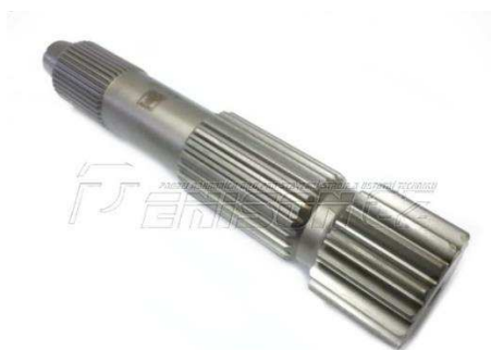
Obr. 38 – Ozubení zhotovené na hřídeli [19]
