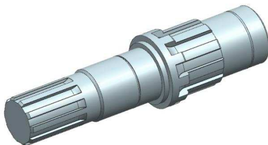
Obr. 21 – Model hřídele ozubeného kola
