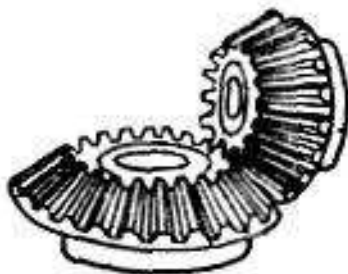
Obr. 15 – Kuželové soukolí s přímými zuby [8]
