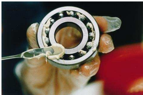
Obr. 35 – Mazání plastickým mazivem [16]
