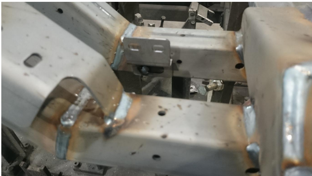
Obrázek 8: Úchyt přichycený pomocným svarem
