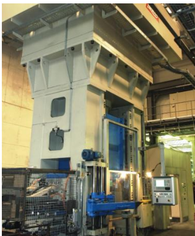
Obrázek 4-10 - Vertikální hydraulický vytlačovací lis s uzavřeným stojanovým rámem firmy Lasco KFP [14]
