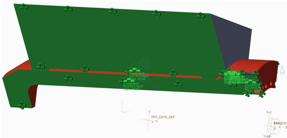
Obrázek 8-15 - Pomocné uchycení sestavy válce a traverzy
