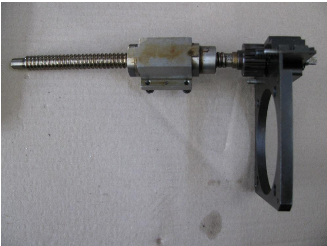
Obrázek 10: Pohybový šroub příčné osy X
