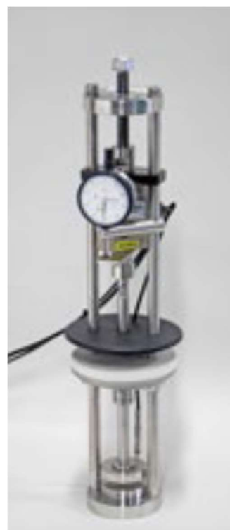
Obrázek 5-16: Relaxační Loading Cell pro měření relaxace v tlaku do 1000 N [15]
