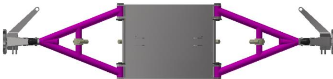
Obrázek 39 Sestava lichoběžníkového zavěšení - pohled z vrchu [Vlastní zdroj]
