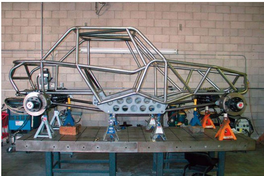
Obrázek 5 - Svařený rám na montážním stole viz. [8]
