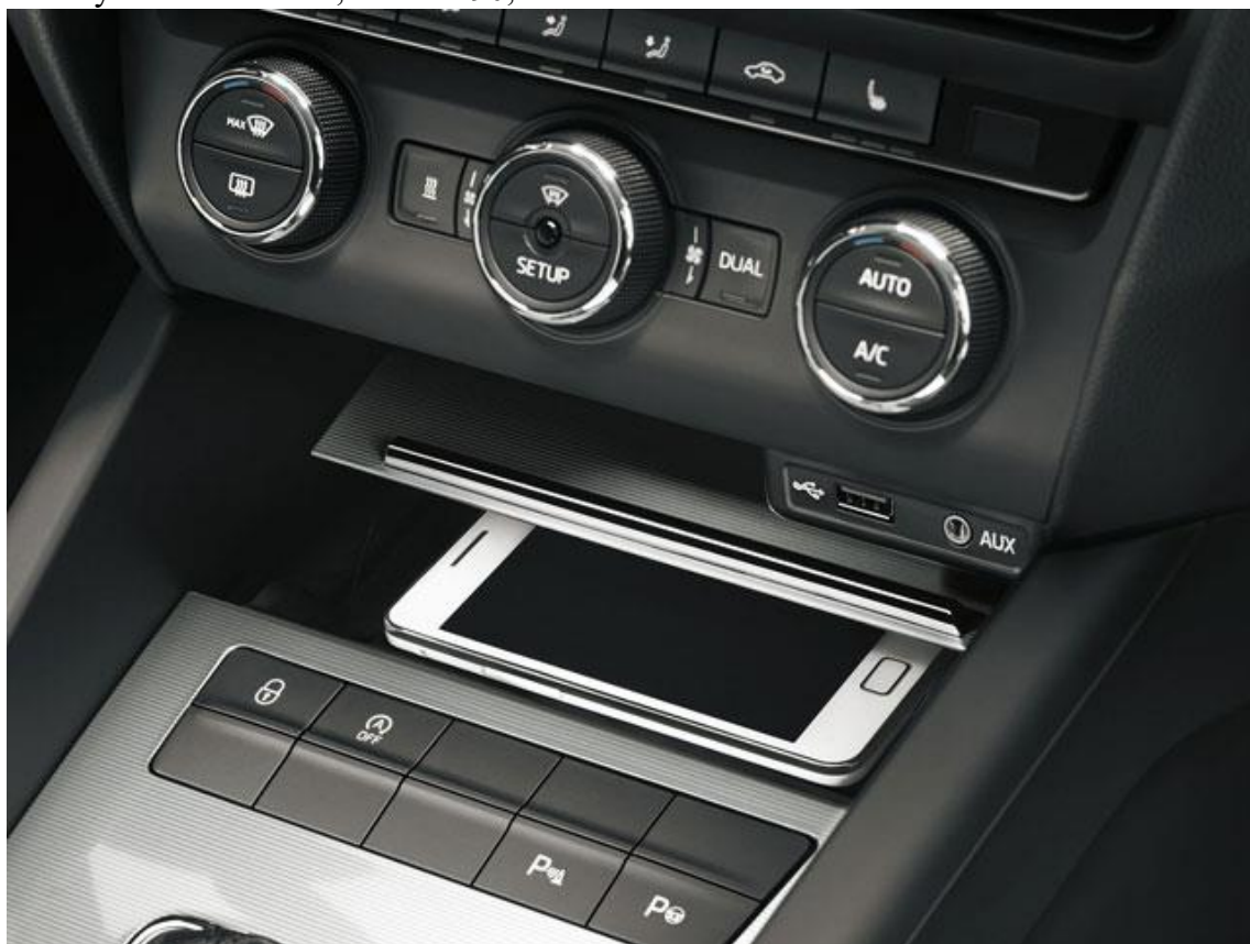
Obr. 7 Uzavíratelný box pro smartphone s bezdrátovou nabíječkou ve spodní části (Škoda Octavia 3) [7]
