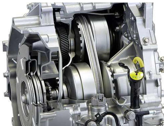
Obr. 5. – Řez variátorovou převodovkou [11]
