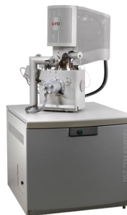
Obr. 23 - Termoemisní SEM Quanta 200 od firmy FEI s EDX detektorem (mikrosonda) od firmy EDAX [75].
