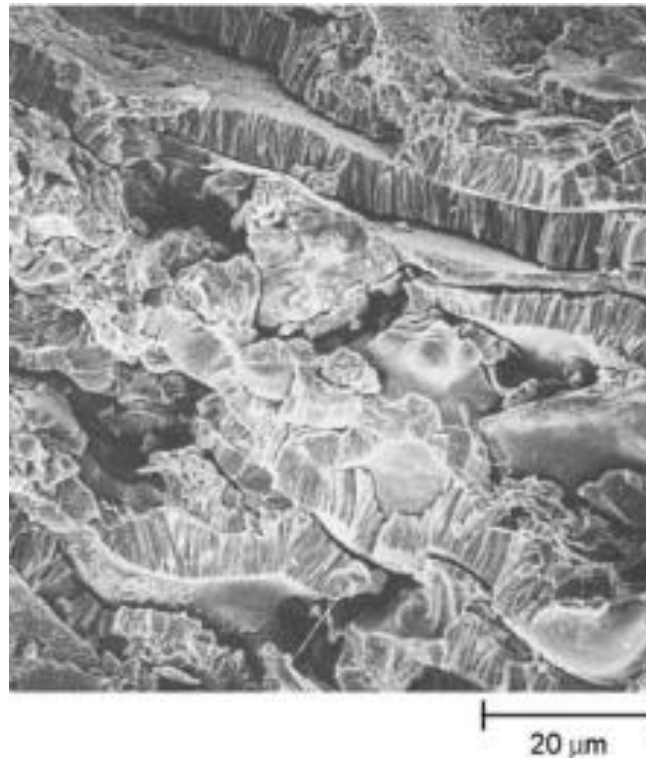
Obr. 13 - Snímek ze skenovacího elektronového mikroskopu. Plazmový žárový nástřik povlaku na bázi wolframu a jeho lamelární struktura [32].
