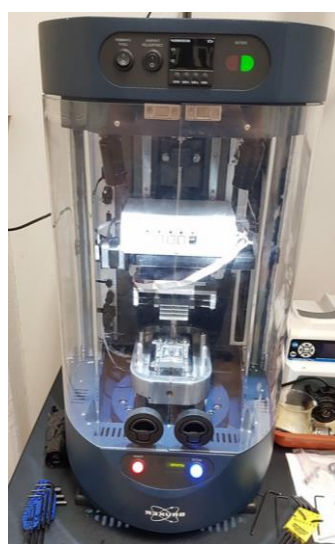
Obr. 27 – Tribometr Bruker CETR-UMT 3.
