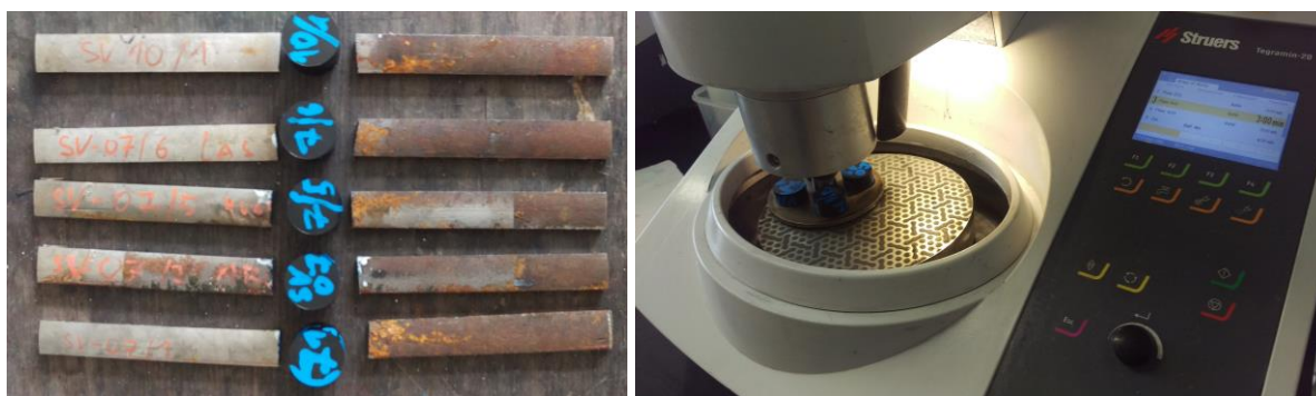
Obr. 53, 54: Příprava metalografických výbrusů po expozici [v.z.]
