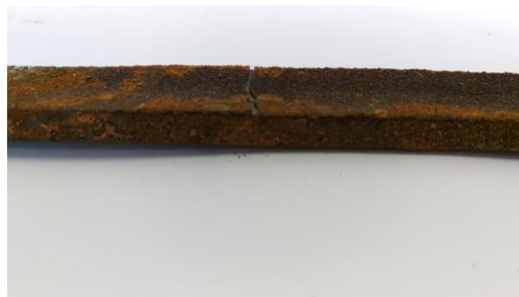
Obr. 63: Ztráta adheze povlaku HVOF po expozici Obr. 64: Ztráta adheze povlaku AS po expozici
