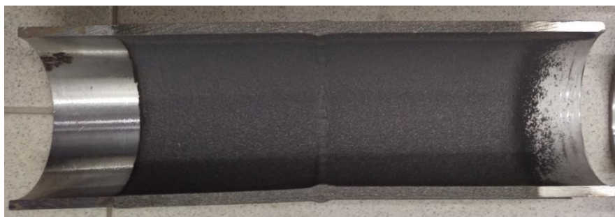
Obr.24: Povlak aplikovaný metodou AS [v.z.]
