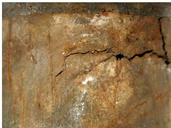
Obr.7: Makrosnímek SSC porušení materiálu 316Ti [21] Obr. 8: Mikrosnímek SSC interkrystalické trhliny [21]
