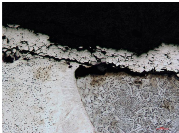
Obr. 59: Korozní napadení referenčního vzorku Obr. 60: Korozní napadení vzorku s povlakem HVOF
