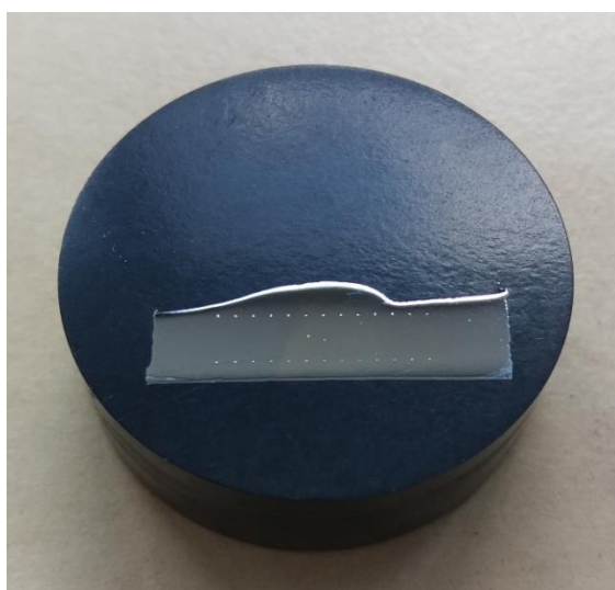
Obr. 39: Vtisky měření průběhu tvrdosti SV-07
