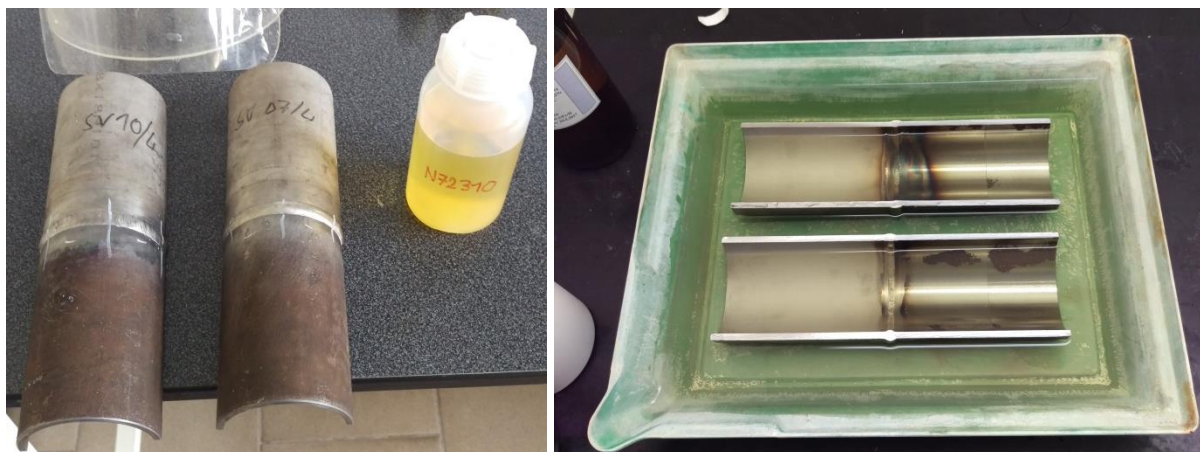
Obr. 27, 28: Příprava vzorků a aplikace inhibičního přípravku [v.z.]
