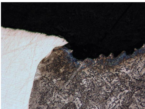
Obr. 59: Korozní napadení referenčního vzorku Obr. 60: Korozní napadení vzorku s povlakem HVOF
