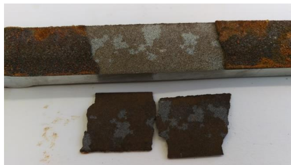
Obr. 65: Korozní produkty pod nástřikem HVOF Obr. 66: Korozní produkty pod nástřikem AS
