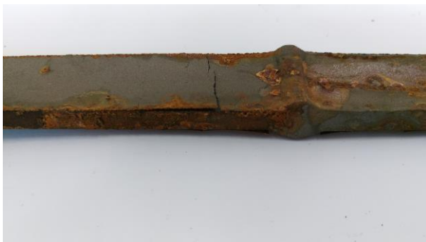
Obr. 63: Ztráta adheze povlaku HVOF po expozici Obr. 64: Ztráta adheze povlaku AS po expozici
