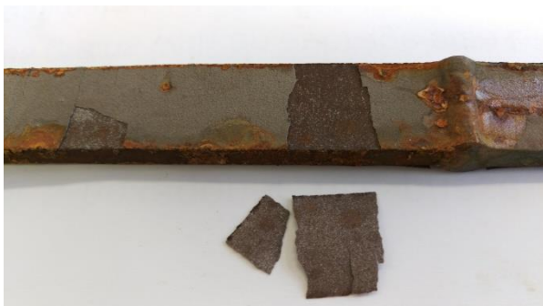
Obr. 65: Korozní produkty pod nástřikem HVOF Obr. 66: Korozní produkty pod nástřikem AS
