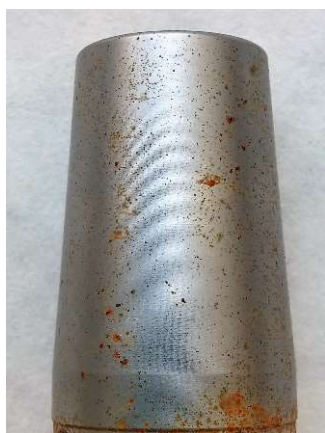
Obr. 6-18 Porovnání korozní napadení upínací stopky, vzorek K-2
