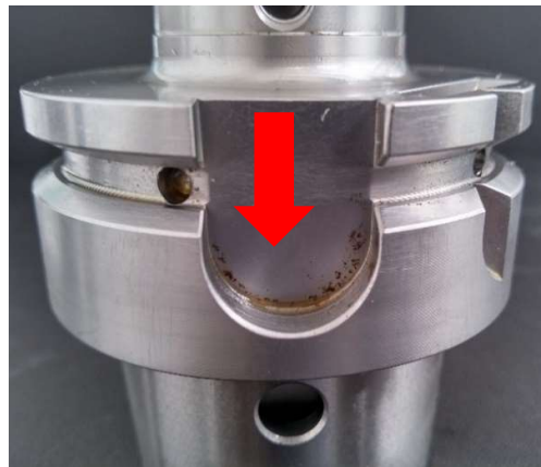
Obr. 6-8 Koroze v prohlubni na přírubě, vzorek 1-E
