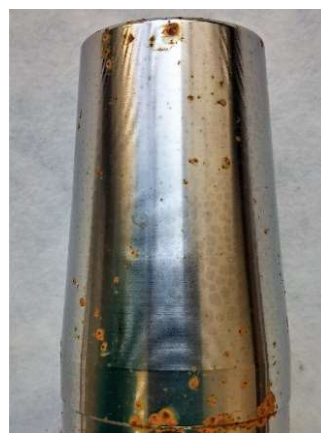
Obr. 6-19 Porovnání korozní napadení upínací stopky, vzorek O-2
