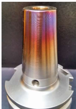
Obr. 6-32 Popouštěcí barvy po prvním cyklu, vzorek 1-A
