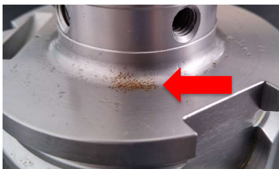
Obr. 6-3 Korozní napadení vzorku 1-C
