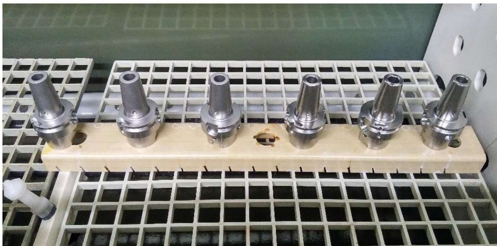
Obr. 6-13 Rozmístění vzorků v korozní komoře u testu 2
