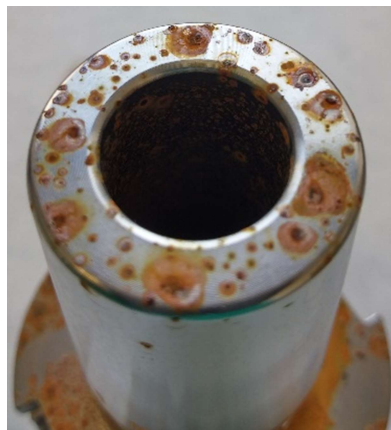
Obr. 6-17 Porovnání korozního napadení na čele stopky, vzorek O-2
