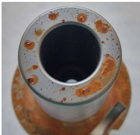
Obr. 6-16 Porovnání korozního napadení na čele stopky, vzorek K-2
