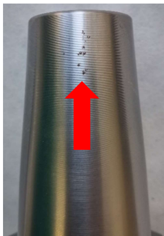
Obr. 6-5 Korozní napadení na upínací stopce vzorku 1-D
