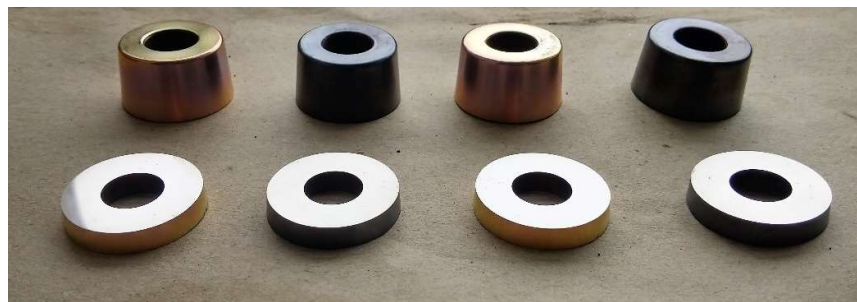
Obr. 6-37 Odebrané části vzorků pro světelnou a elektronovou mikroskopii
