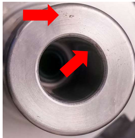
Obr. 6-6 Korozní napadení na čele stopky u vzorku 1-E
