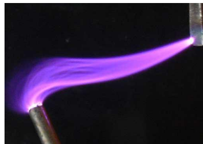
Obr. 12 a 13 – řez elektrickým obloukem / elektrický oblouk mezi dvěma elektrodami. [11]
