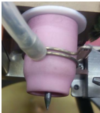
Obr. 34 – detail svařovací hubice s WLa elektrodou.
