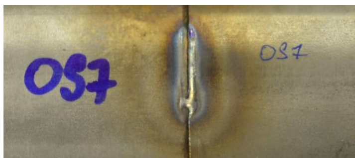
Obr. 60 – propálený základní materiál u svaru OS7.
