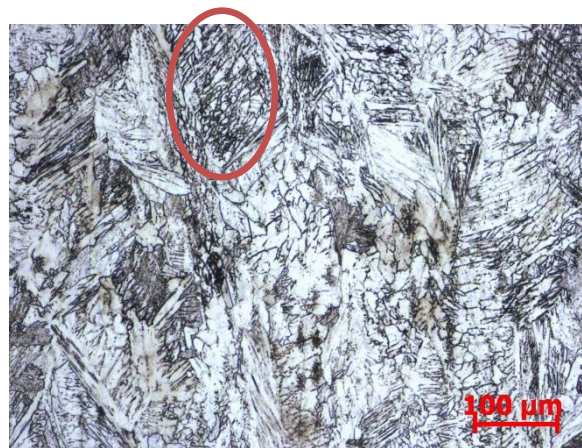
Obr. 89 – osa svaru svarového spoje OS3, zvětšeno 100x. [24]
