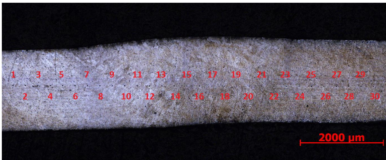
Obr. 80 – poloha a označení vtisků mikrotvrdosti u svaru OSI. [24]
