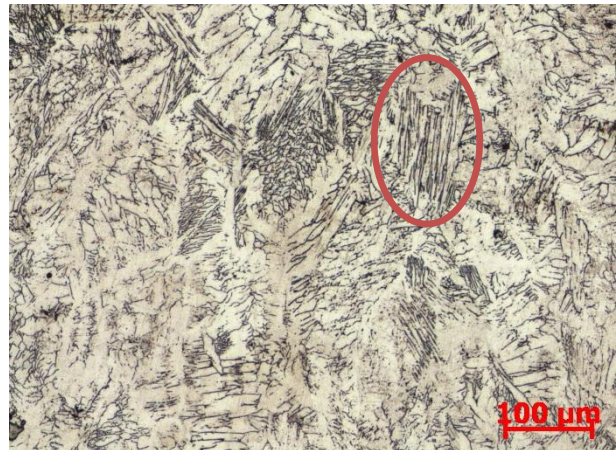
Obr. 86 - osa svaru svarového spoje OS2, zvětšeno 100x. [24]
