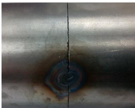
Obr. 42 – detail sestehované trubky.
