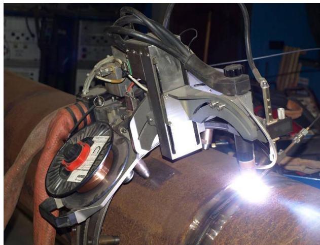
Obr. 26 – otevřená svařovací orbitální hlavice s přidavným drátem. [19]
