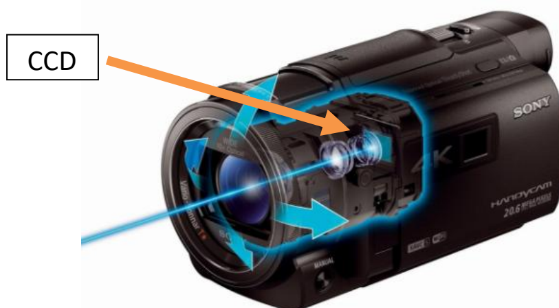
Obr. 6 – proud fotonů procházející v kameře soustavou čoček a dopadající na obrazový snímač. [5]
