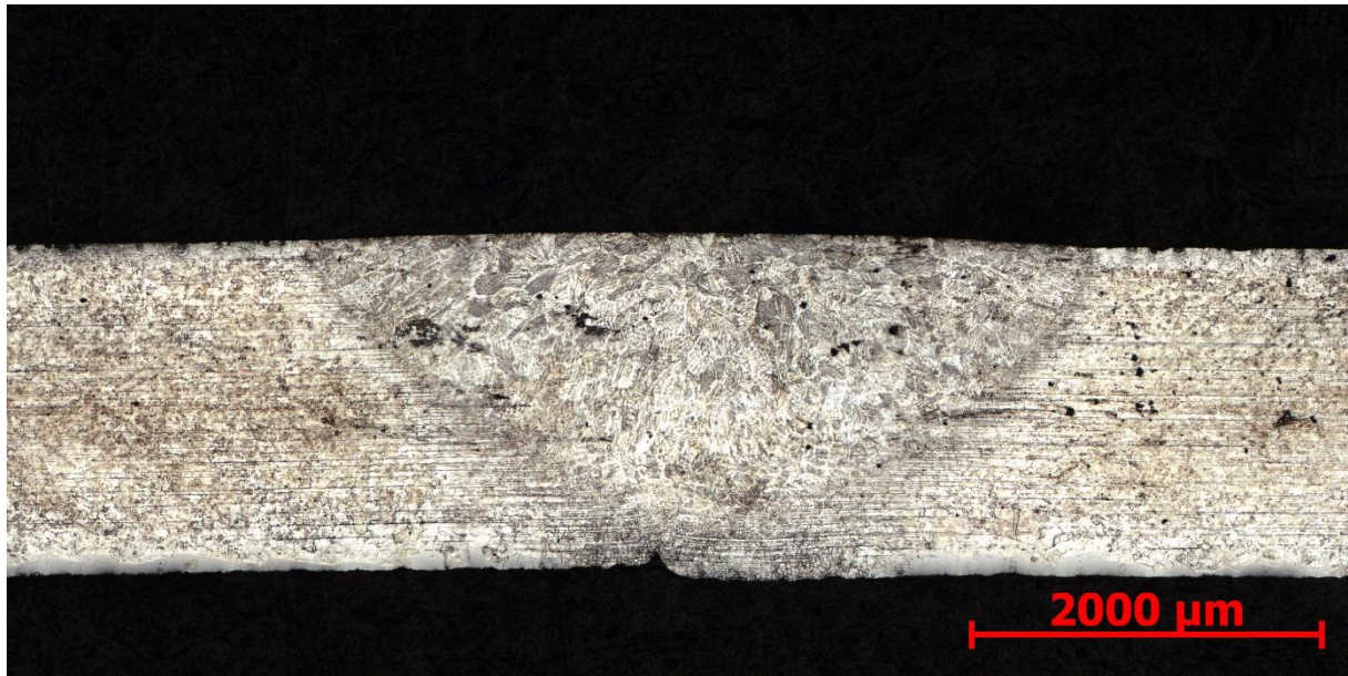
Obr. 84 – makrostruktura svaru OS2, zvětšeno 25x. [24]
