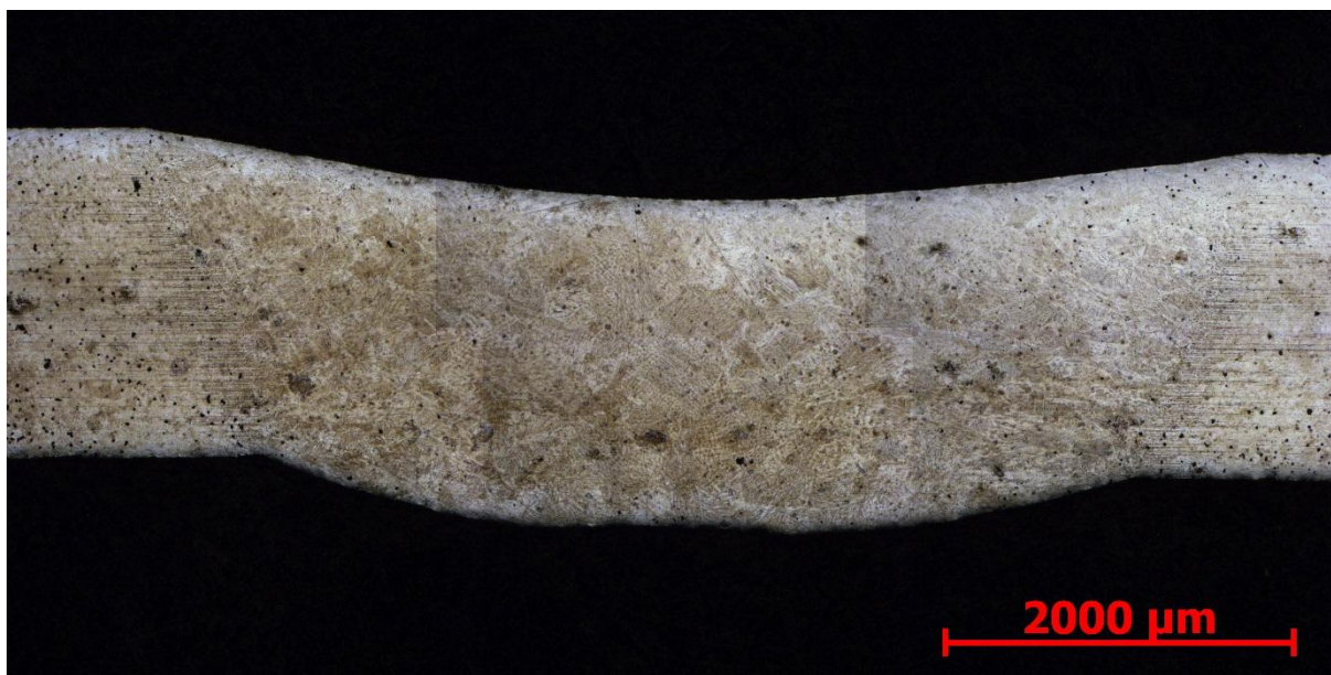
Obr. 90 – makrostruktura svaru OS4, zvětšeno 25x. [24]
