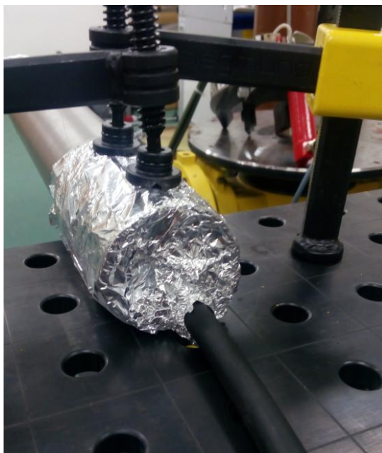
Obr. 44 – improvizované ucpávky z Al folie a přívod formovacího plynu dovnitř svařované trubky.
