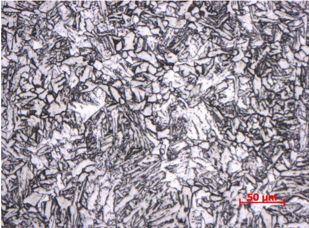
Obr. č. 50 - Mikrostruktura zk. bloku z HR17060 - P5B-2 (5 mm od povrchu zk. bloku). Zvětšení 200x. Feriticko - perlitická struktura, přibývající perlitická struktura
