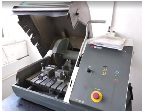
Obr. č. 34 - Laboratorní kotoučová pila Struers Discotom-6
