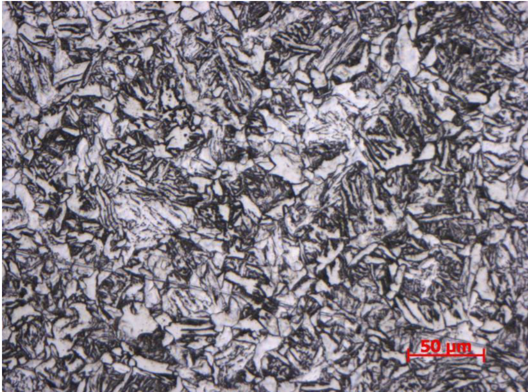
Obr. č. 86 - Mikrostruktura zk. bloku z HR17060 - P5C-2 (5 mm od povrchu zk. bloku). Zvětšení 200x. Feriticko - perlitická struktura, přibývající perlitická struktura
