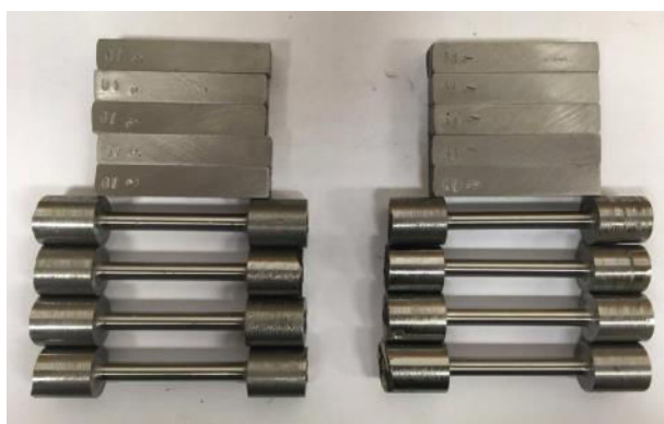
Obr. č. 46 - Zkušební vzorky pro zkoušku tahem a zkoušku rázem v ohybu
