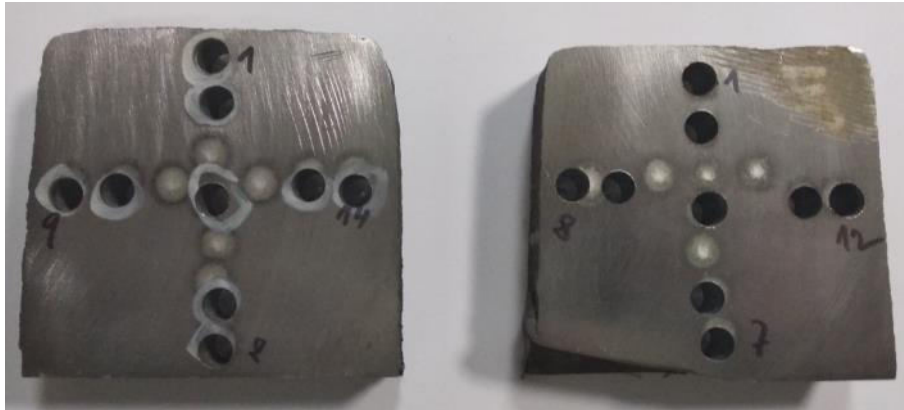
Obr. č. 33 - Detail značení chemických analýz na vzorcích ze zk. bloku z HR18101
