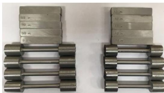
Obr. č. 59 - Zkušební vzorky pro zkoušku tahem a zkoušku rázem v ohybu
