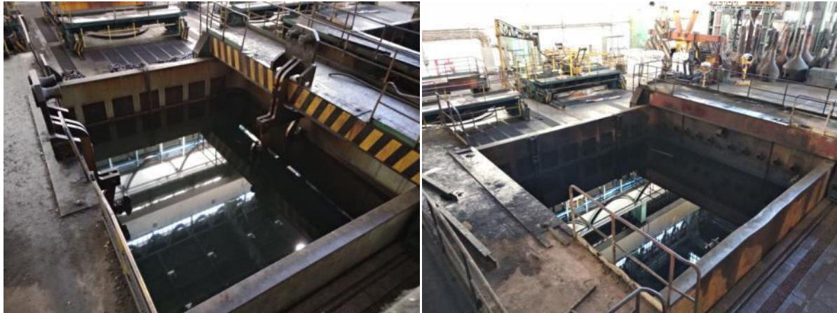
Obr. č. 26 a č. 27 - Nádoby s kalicí lázní - Voda, olej
