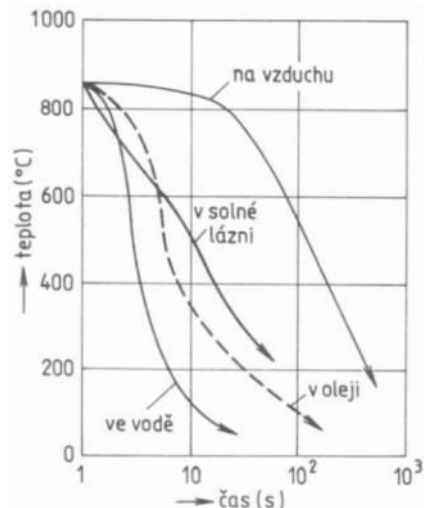
Obr. č. 6 - Průběh ochlazování při kalení do různých prostředí [4].
