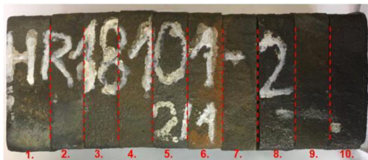
Obr. č. 30 - Provedení rozřezu a označení zkušebního bloku z HR18101
