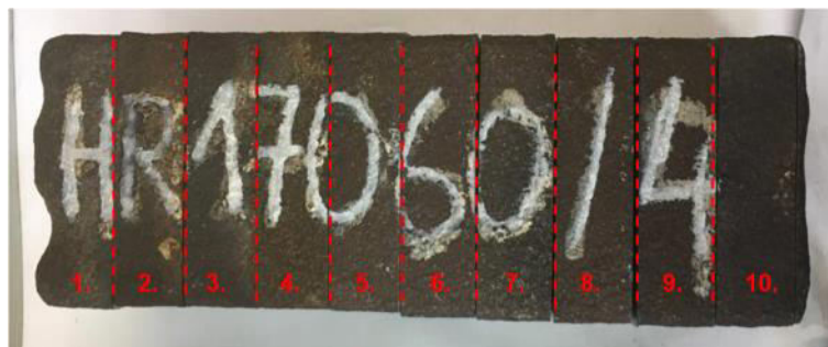
Obr. č. 29 - Provedení rozřezu a označení zkušebního bloku z HR17060
