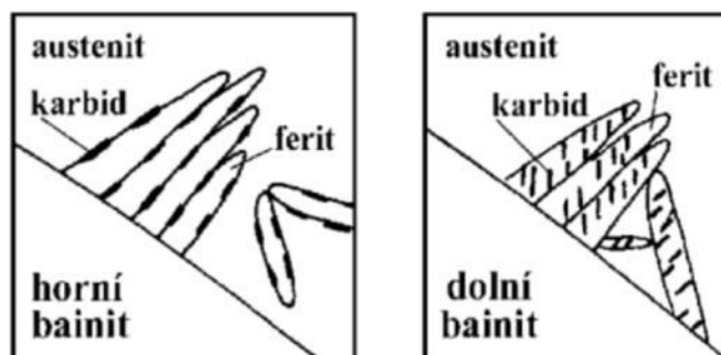
Obr. č. 17 - Struktura horního a dolního bainitu [7]
