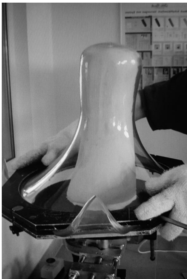
Obrázek 28 Výroba zkušebního KD lůžka metodou hlubokého tažení
