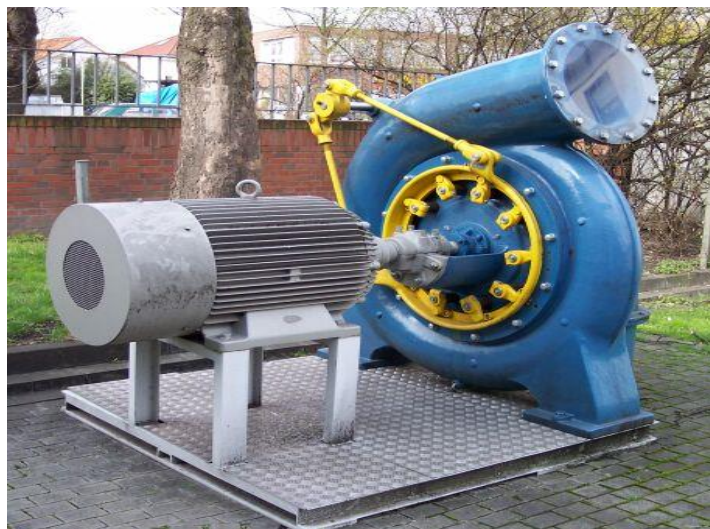
Obr. 2.2. Francisova turbína s generátorem
