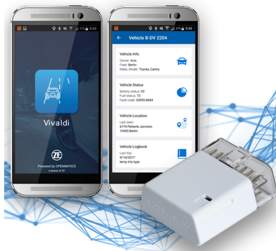
OBRÁZEK 2.2: Zařízení s názvem Vivaldi Box, určené pro sběr dat v osobních vozidlech a mobilní aplikace, která obsahuje vizualizaci těchto dat.
