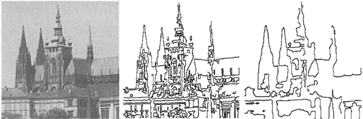
Obrázek 1.6: Příklad užití Cannyho hranového detektoru s různou velikostí Gaussiánu Zdroj: [10]
