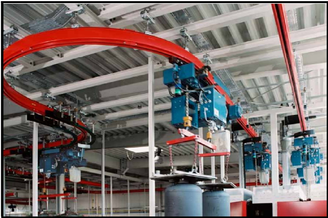
Obrázek č. 9 Podvěsná dráha jednokolejná [11]
