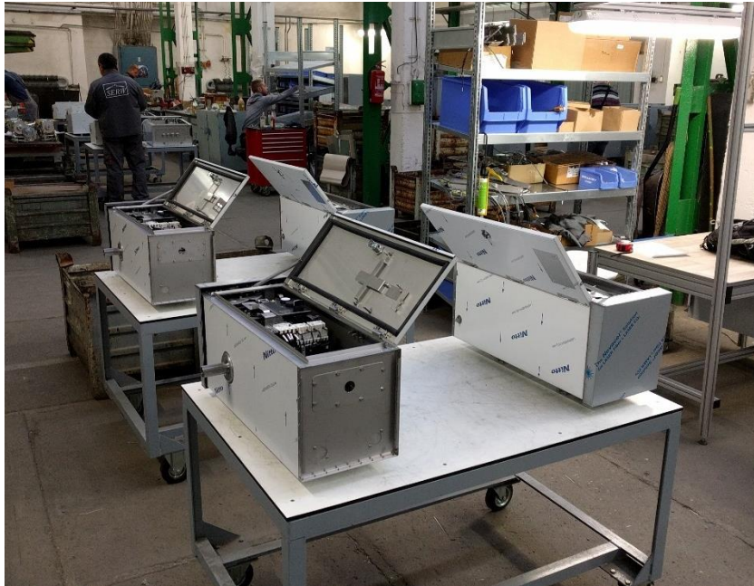
Obrázek 22 - Pracoviště montáže skříně MDR3
