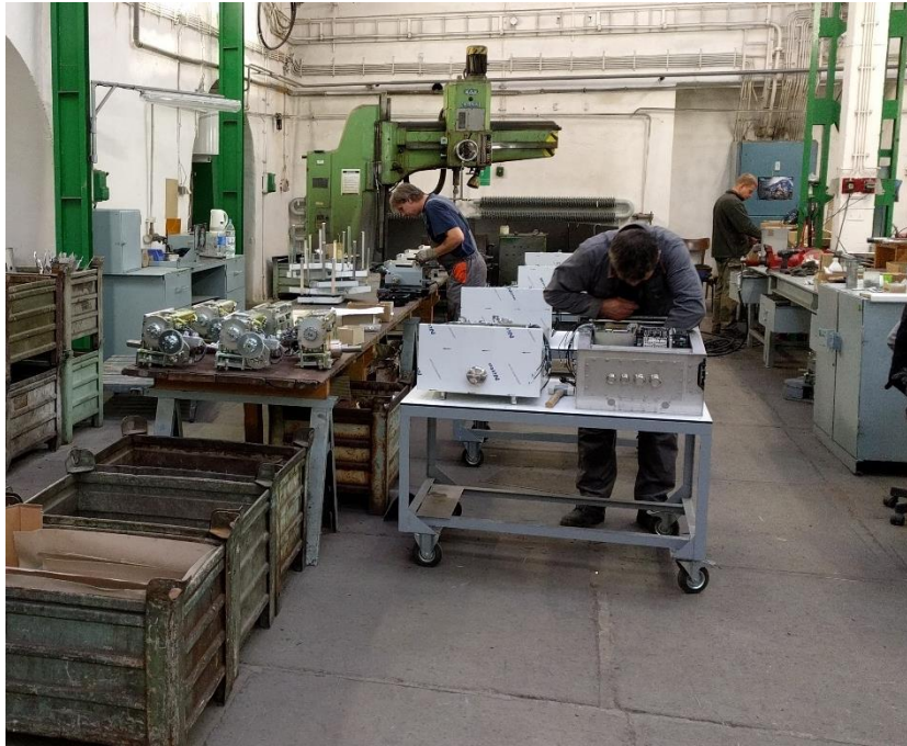
Obrázek 26 - Pracoviště montáže skříně PMR5
