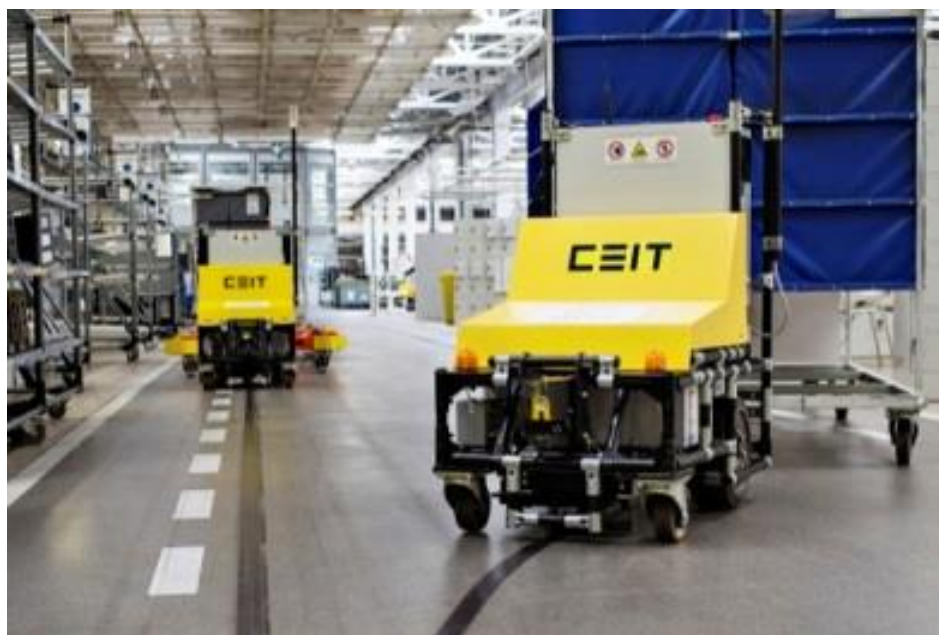
Obr. 4-10 Plně automaticky řízené přepravní vozíky ve skladu
