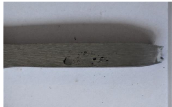
Obr. 44 Vzorek 7 – Během tahové zkoušky se počaly na povrchu vzorku v místě svaru objevovat drobné vady. Také se zde začal tvořit druhý krček na opačné straně.
