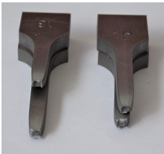
Obr. 46 – Zleva vzorky 12, 13 –Nesvařovaný materiál – kombinovaný lom.
