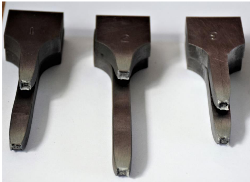
Obr. 45 Zleva vzorky 1, 2, 3 – Vzorky 1 a 2 přetrženy v základním materiálu. Vzorek tři rozhraní svarový kov TOO. Na vzorcích je patrný kombinovaný lom.
