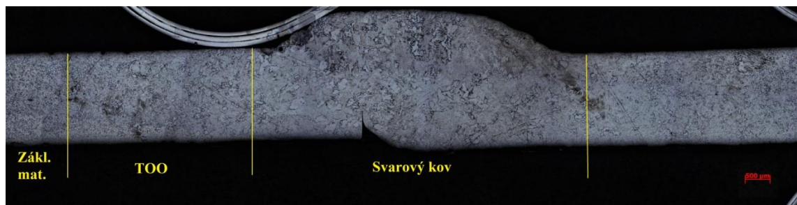
Obr. 26 Svar S235 JRG – TIG při zvětšení 25x
