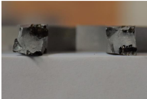
Obr. 37 Vzorek 17 - Na lomu je možné zaznamenat jednu větší vadu napříč svarovým kovem kolmou k povrchu zkušebního tělesa v místě kořene svaru. V místě vady došlo ke křehkému lomu zbytek lomu je tvárný.
