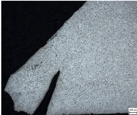
Obr. 50 Vzorek č. 5 – Lom odštěpení v místě výskytu okuje 50x
