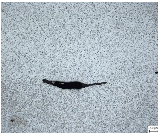
Obr. 60 Vzorek č. 11 – Vada ve svarovém kovu 50x
