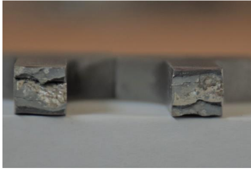
Obr. 35 Vzorek 15 - Na lomové ploše je patrný zub od dolomení. Dále jsou zde patrné drobné částičky okují. Lom probíhá ve svarovém kovu pod cca 15° úhlem. Jedná se o křehký lom.
