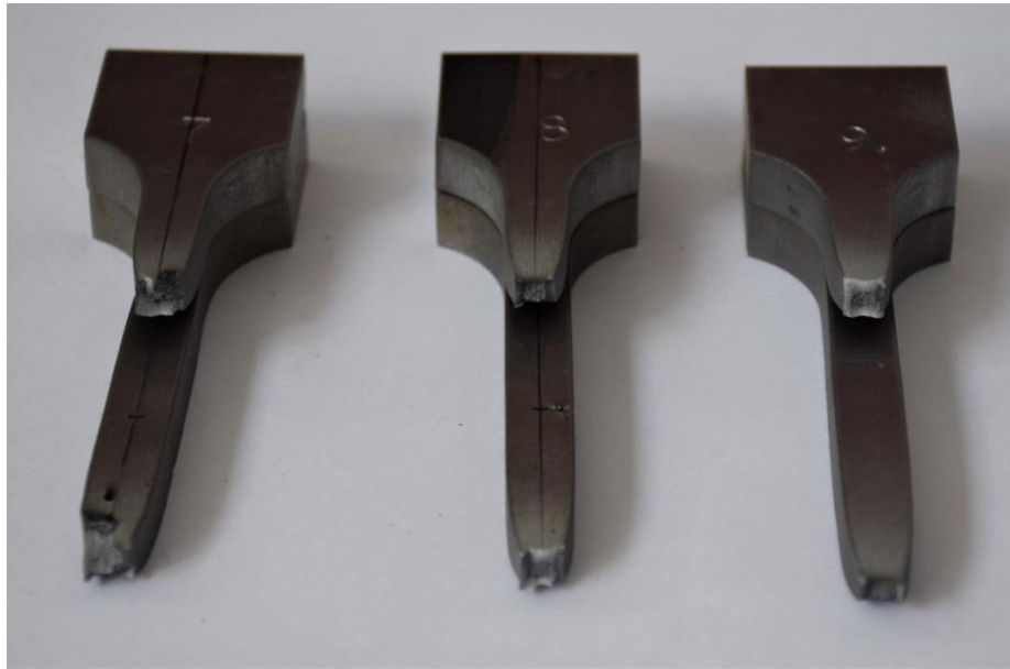
Obr. 42 Zleva vzorky 7, 8, 9 –Vzorky 8 a 9 byly přetrženy v základním materiálu. Je u nich patrný kombinovaný lom, který je typický pro tuto ocel při jednoosém namáhání v tahu. U vzorku 7 počal lom od vrubu, který byl zaznamenán při vizuální zkoušce.
