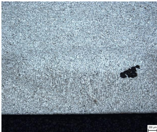
Obr. 55 Vzorek č. 7 – Strukový vměstek v místě kořene 50x
