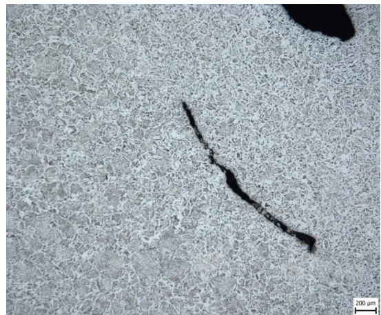
Obr. 61 Vzorek č. 11 – Vada na rozhraní svarový kov TOO, vada ve svarovém kovu. 50x
