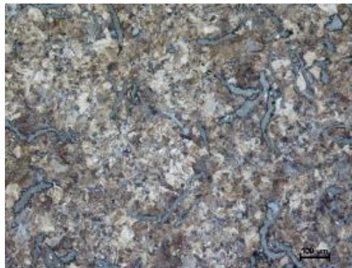
Obr. 29 LT10187 V1 2/3-2; na snímku zachycena směs perlitu a bainitu, stopové množství feritu a ledeburit; zvětšeno 100x
