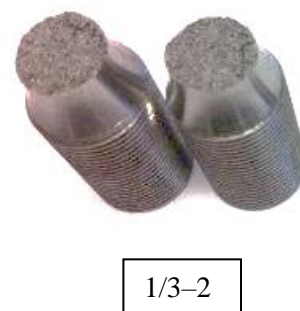
Obr. 23 Přetržené zkušební tyče pro spodek odlitku V1
