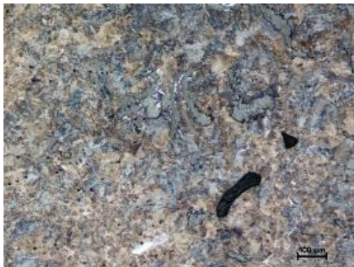
Obr.28 LT10187 V1 2/3-1; na snímku zachycen perlit, malé množství bainitu, stopové množství feritu a malé množství hrubého ledeburitu; zvětšeno 100x
