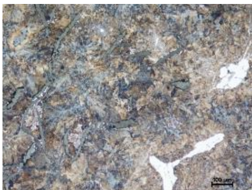
Obr. 30 LT10187 V1 3/3-1; na snímku zachycen perlit, bainit, ledeburit v oblastech drobnějších karbidů a stopové množství feritu; zvětšeno 100x
