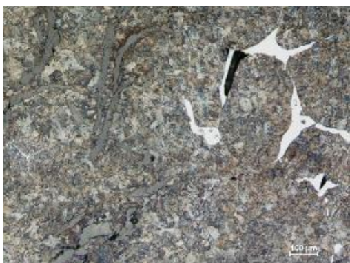
Obr.34 LT10187 V2 2/3-1; na snímku zachycen perlit, malá místa hrubého cementitu netvořící síťoví, menší výskyt jemných karbidů Fe_3C , nitrid, sulfid; zvětšeno 100x
