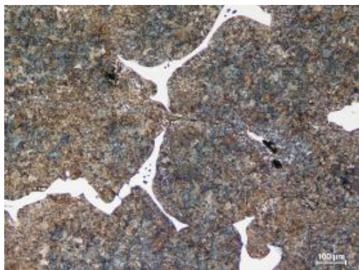
Obr.36 LT10187 V2 3/3-1; na snímku zachycen perlit, malá místa hrubého cementitu netvořící síťoví, malé shluky jemných karbidů Fe_3C ; zvětšeno 100x
