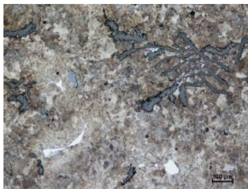
Obr. 31 LT10187 V1 3/3-2; na snímku zachycen perlit, bainit, ledeburit v oblastech drobnějších karbidů a stopové množství feritu; zvětšeno 100x
