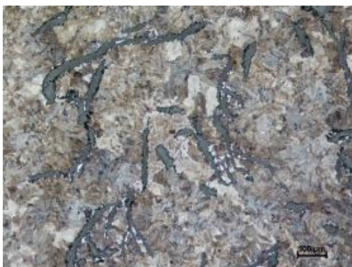
Obr. 26 LT10187 V1 1/3-1; na snímku zachycen perlit, bainit a malé množství feritu, zvětšeno 100x
