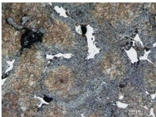
Obr.32 LT10187 V2 1/3-1; na snímku zachycen perlit, malé množství hrubého cementitu netvořící síťoví a menší výskyt jemných karbidů Fe_3C ; zvětšeno 100x
