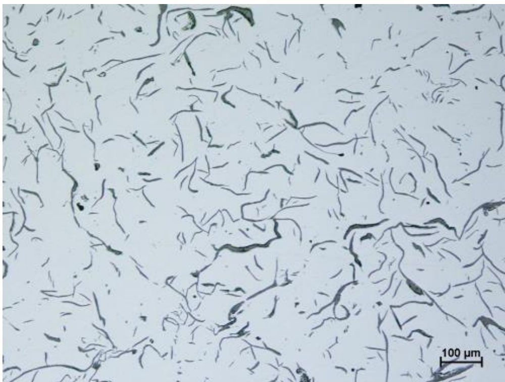
Obr. 2 Tvar a rozložení grafitu v LLG, zvětšeno 100x
