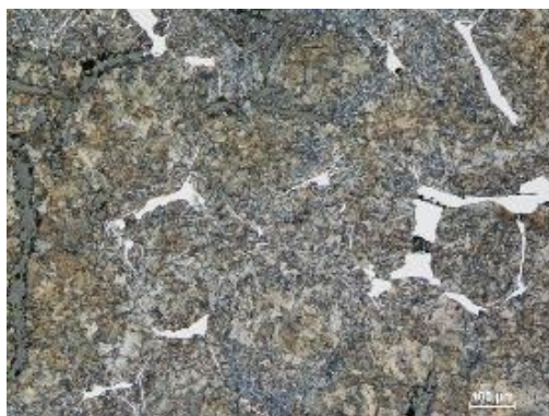
Obr.35 LT10187 V2 2/3-2; na snímku zachycen perlit, malá místa hrubého cementitu netvořící síťoví, malé shluky jemných karbidů Fe_3C ; zvětšeno 100x
