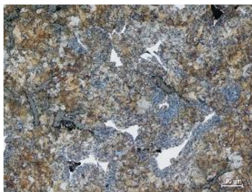
Obr.33 LT10187 V2 1/3-2; na snímku zachycen perlit, malé množství hrubého cementitu netvořící síťoví a menší výskyt jemných karbidů Fe_3C ; zvětšeno 100x
