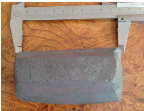
Obr. 46 Polotovar pro kování v kovádlech eliptického průřezu
