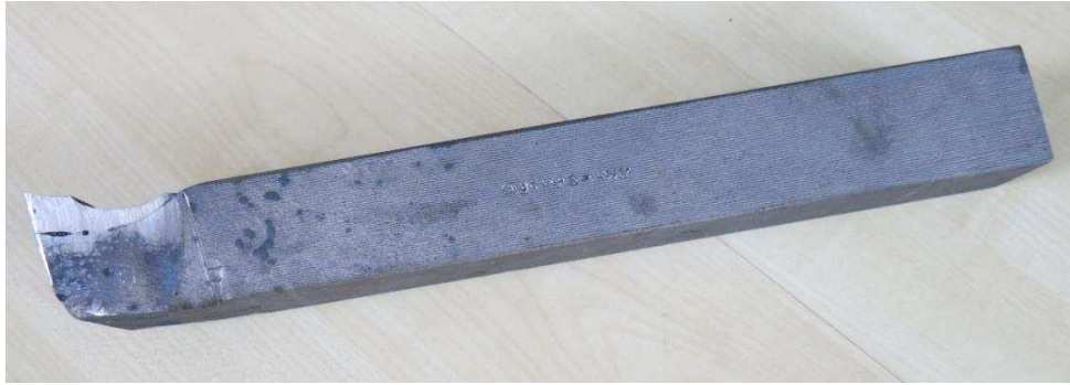
Obr. 35 Kovaný soustružnický nůž
