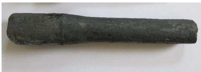
Obr. 40 Výsledný polotovar pro sonotrodu
