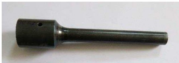
Obr. 36 Sonotroda pro ultrazvukové svařování [12]
