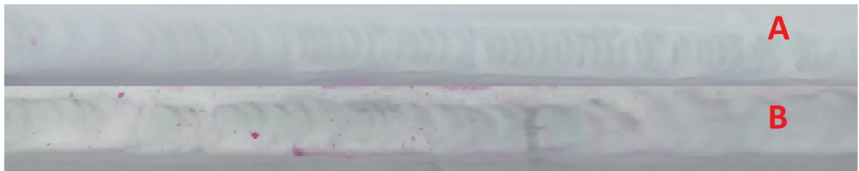
Obrázek 16 Kapilární zkouška b
