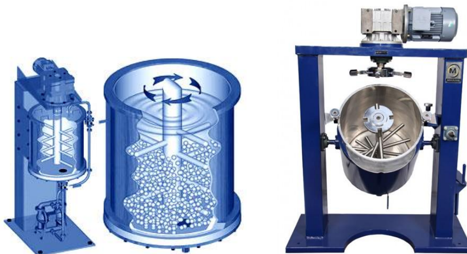
Obr. 2 a 3: Schéma atritoru [5] a reálný atritor [6]
