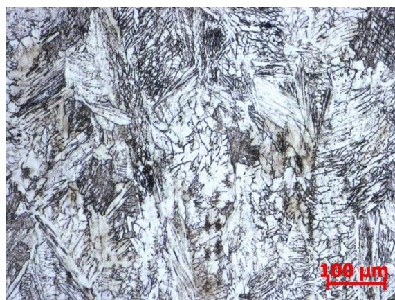
Obrázek 31 - Osa svaru svarového spoje OS3 M1, zvětšeno 100x
