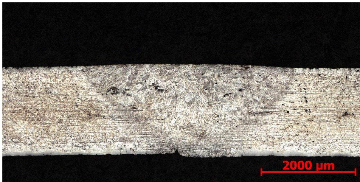
Obrázek 23 - Makroskopické zachycení svarového spoje OS2 M1, zvětšeno 25x
