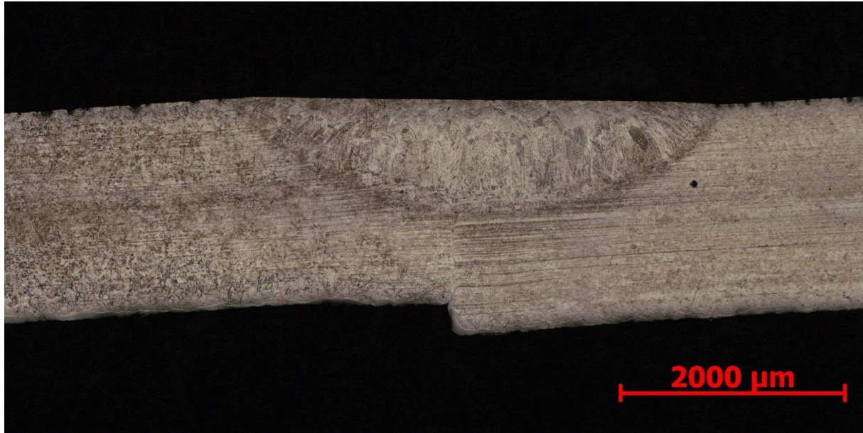
Obrázek 26 - Makroskopické zachycení svarového spoje OS2 M2, zvětšeno 25x
