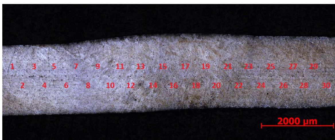
Obrázek 49 - Poloha a označení vtisků mikrotvrdomosti svaru OS1
