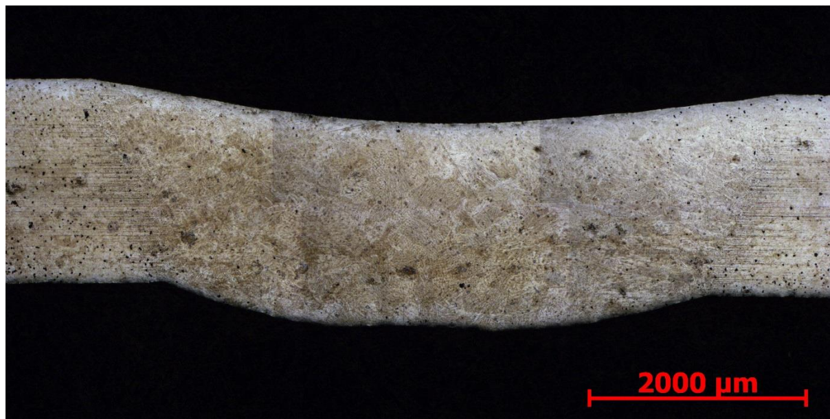
Obrázek 35 - Makroskopické zachycení svarového spoje OS4 M1, zvětšeno 25x
