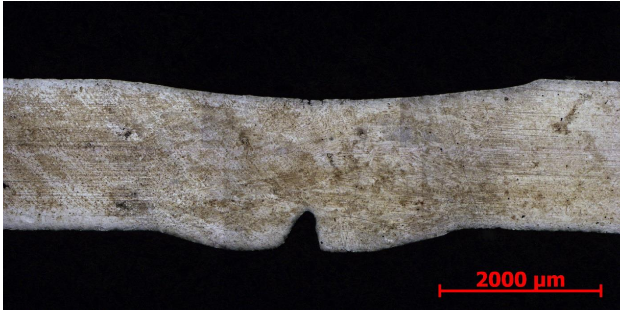
Obrázek 38 - Makroskopické zachycení svarového spoje OS4 M2, zvětšeno 25x
