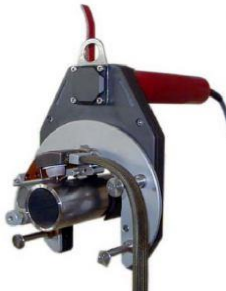
Obrázek 15 - Otevřená hlava Polysoude MUIV 115 AVC/OSC [29]
