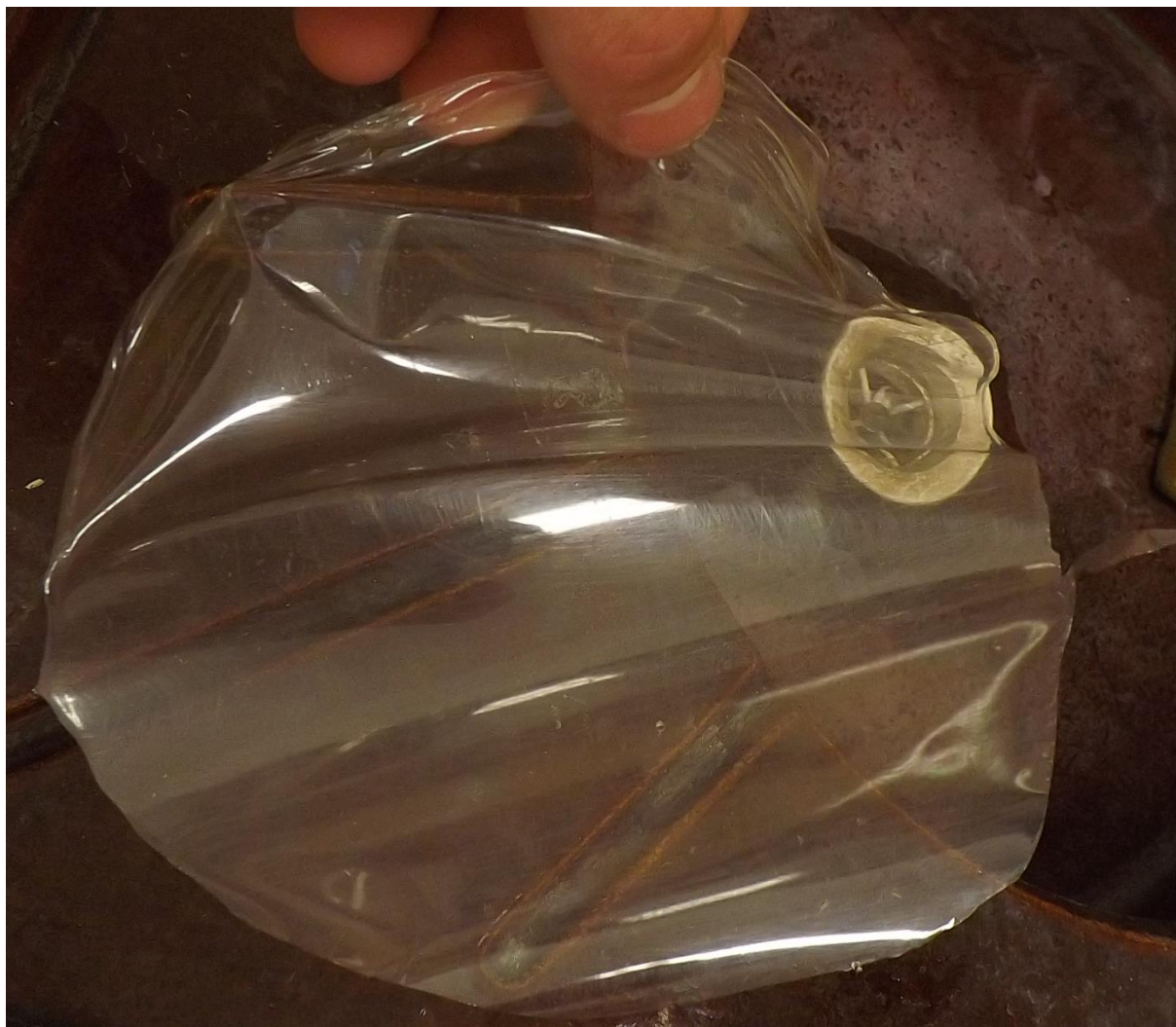
Obrázek 19 Syntetizovaná membrána - nepravidelnost byla způsobena nepatrným nakloněním pece.
