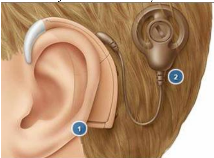
Obrázek 2: vnější část kochleárního implantátu
