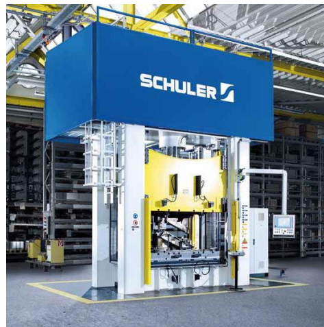
OBRÁZEK 5 HYDRAULICKÝ LIS SCHULER
