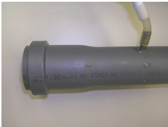
Obr. 1.7 Příklad umístění odběru na dlouhé trubce
