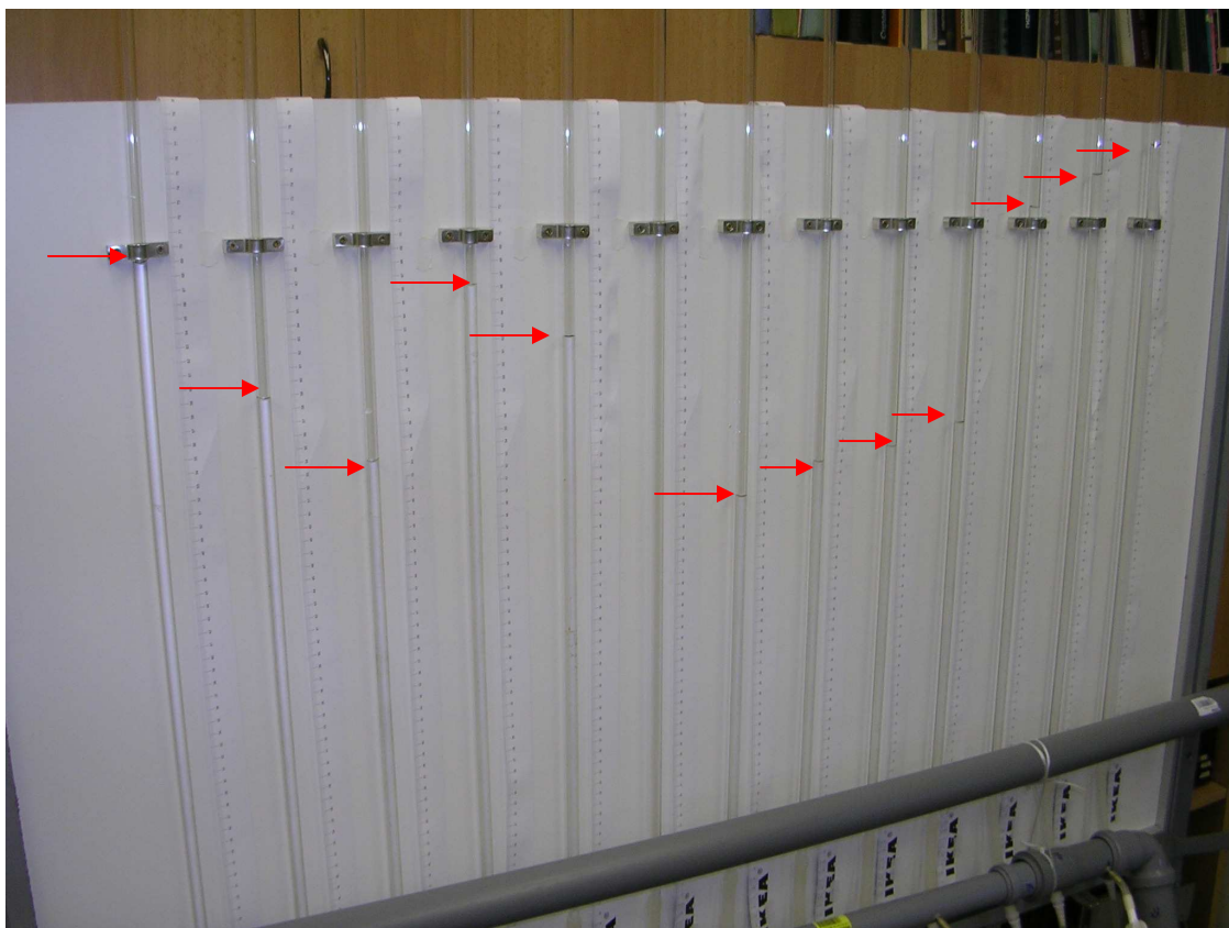
Obr. 3.4 Pohled na výšky vodních sloupců v trubicích při měření s vyznačením hladin
