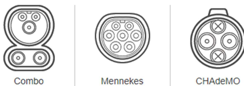
Obrázek 13 : Standardní konektory umožňující připojení nabíjení [20]
