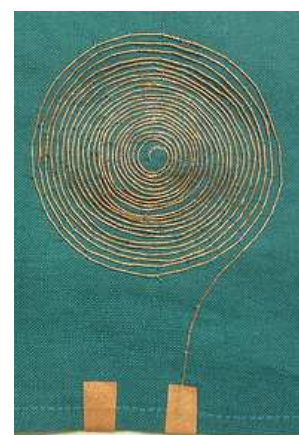
Obrázek 2-3 Příklad vyšité spirálové cívky měděnou nití [9]
