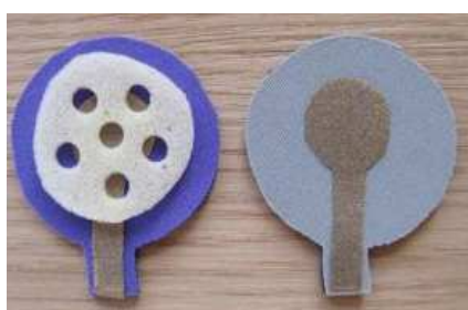
Obrázek 3-2 Ukázka možného sestavení látkového tlačítka. [16]
