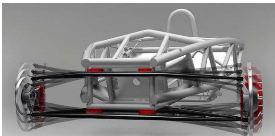
Obrázek 4-2 Koncept Lift, který by měl obsahovat piezoelektrická vlákna [1]
