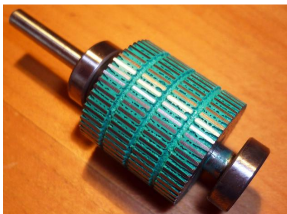
Obr. 2-6 Příklad rotoru krokového motoru s permanentními magnety
