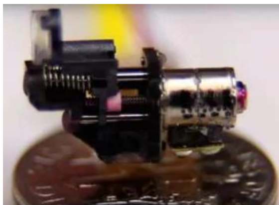
Obr. 4-2 Krokový motor v DVD jednotce [19]
