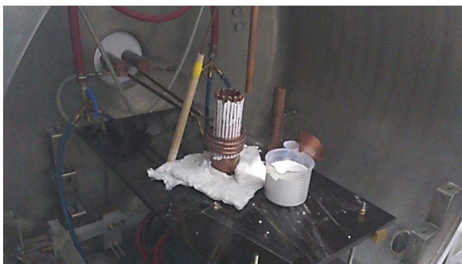
Obr. 2.17 Umístění studeného kelímku v pracovní komoře[Autor]
