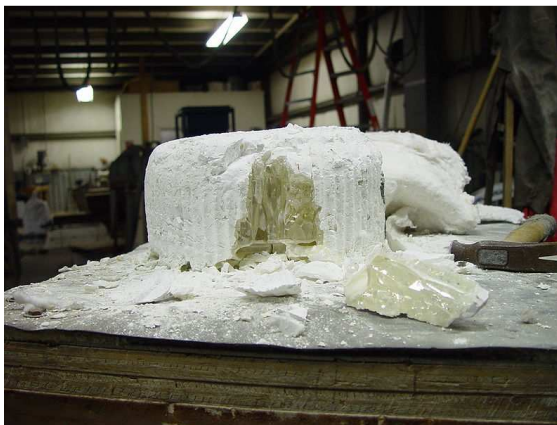
Obr. 2.29 Hotový kubický zirkon po vyjmutí ze studeného kelímku a rozbit[39]
