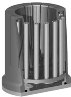
Obr. 2.7 Studený kelímek tvořený lichoběžníkovými segmenty[15]
