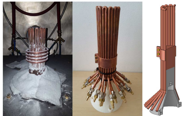
Obr. 2.8 Studený kelímek tvořený válcovými segmenty[16]
