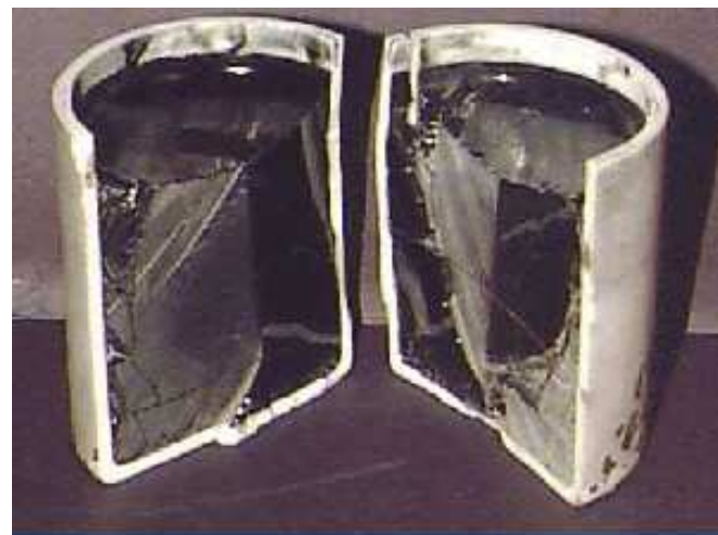
Obr. 2.31 Ingot vitřifikovaného radioaktivního odpadu v nerezovém obalu v řezu [42]
