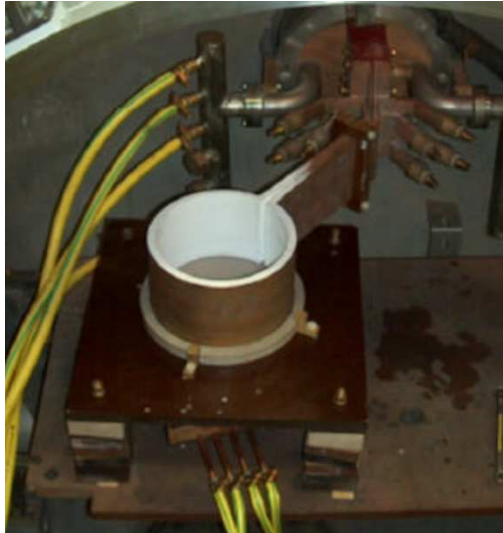
Obr. 2.4 Reálný induktorový kelímek pro tavení skla a oxidů [14]
