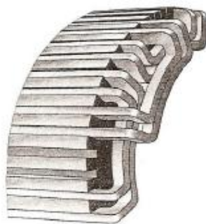
Obr. 1.1 Koncentrické vinutí – převzato z [1]
