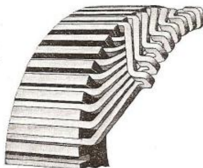
Obr. 1.2 Postupné vinutí – převzato z [1]
