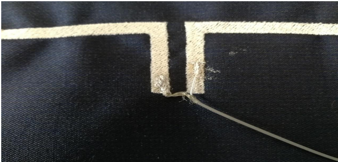
Obr. 33 Dipólová anténa s přírodním koaxiálním kabelem upevněným pomocí stříbrného epoxidového lepidla
