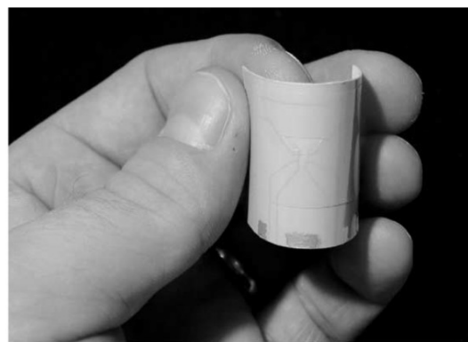
Obrázek 4: Ohebný OECT natisknutý na papírovém substrátu jako senzor vlhkosti [9].
