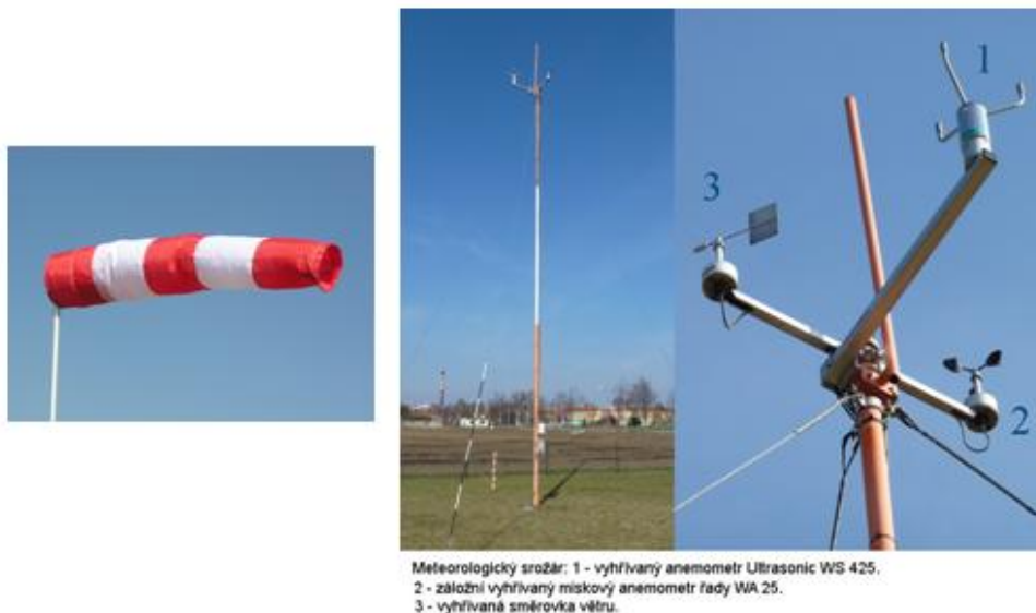
Obrázek 19: Větrný rukáv a přístroje k měření rychlosti a síly větru, (zdroj: czechpilot.cz, Ivan Kain)
