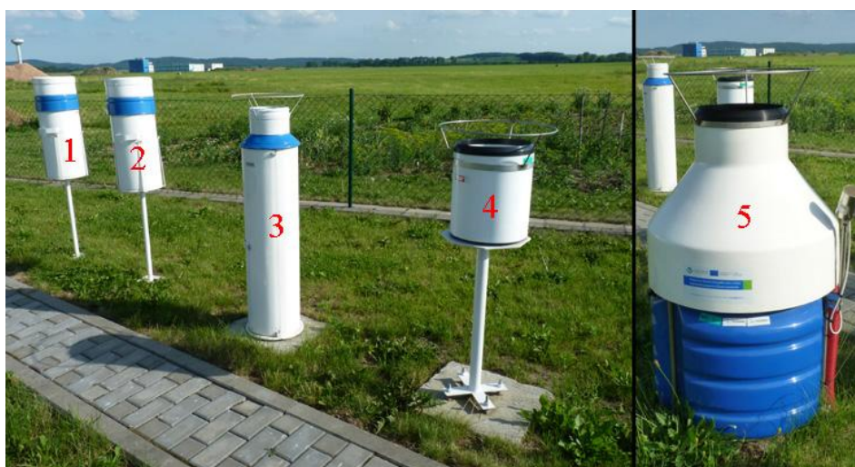
Obrázek 20: Druhy srážkoměrů, 1 a 2 = srážkoměry, 3 = ombrograf, 4 = člunkový srážkoměr, 5 = váhový srážkoměr, (zdroj: Ivan Kain, 2017)
