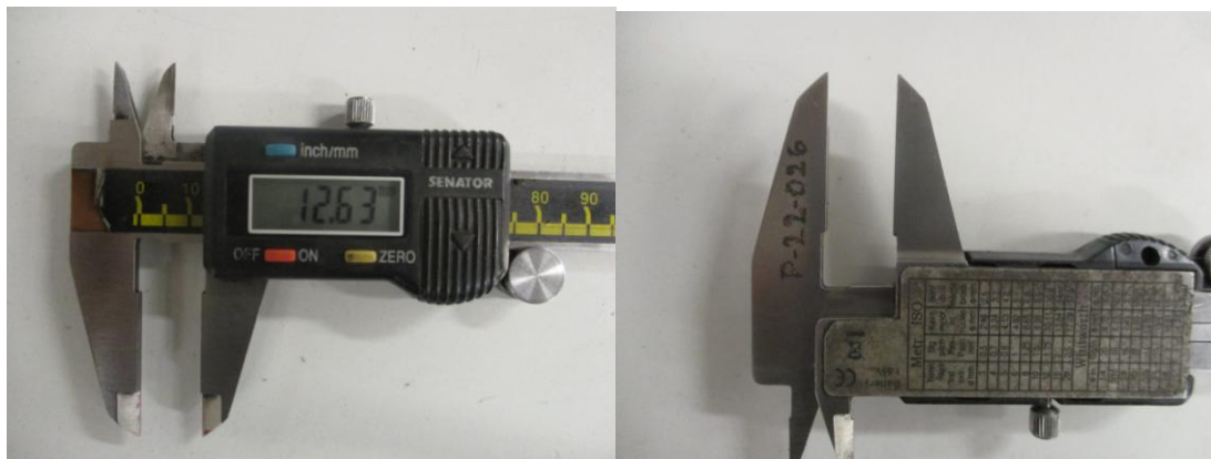
Obrázek 11: Posuvné měřítko bez kalibrační známky - OTK
