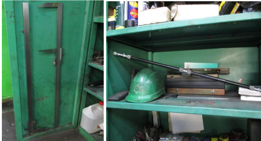
Obrázek 8: Nevhodně uložená měřidla – pracoviště soustruhu 2
