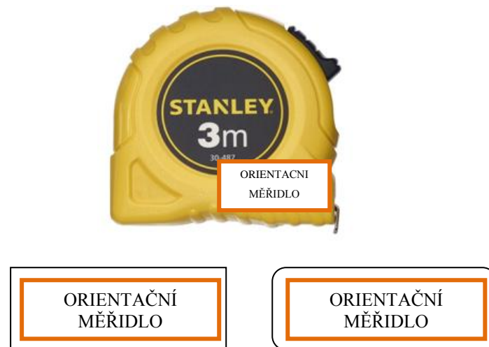
Obrázek 26: Příklad označení orientačního měřidla a typu nálepek
