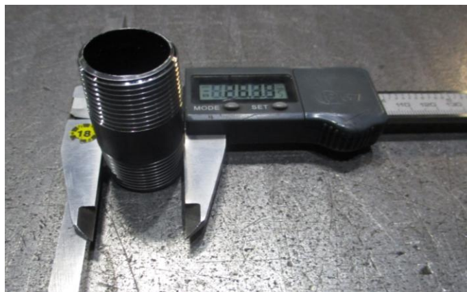
Obrázek 14: Nevhodné měření kuželového závitu R 3/4
