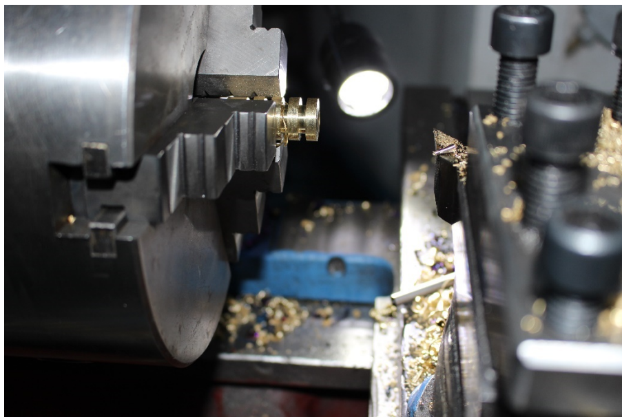
Obr. 35 - Výroba nových bronzových kluzných pouzder
