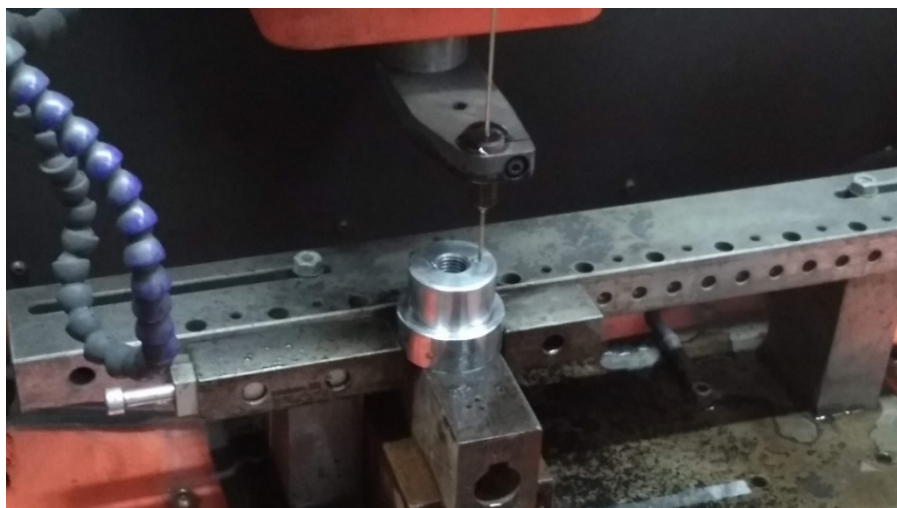
Obr. 36 - Výroba důlku pro navedení vrtáku a následném vyříznutí závitu
