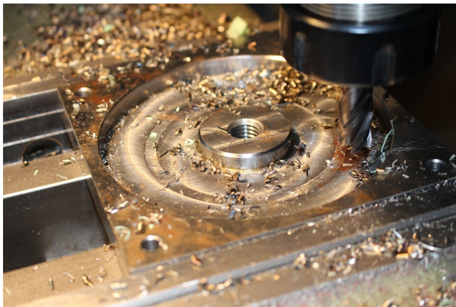
Obr. 34 - Úprava průměrů na spodní desce přípravku
