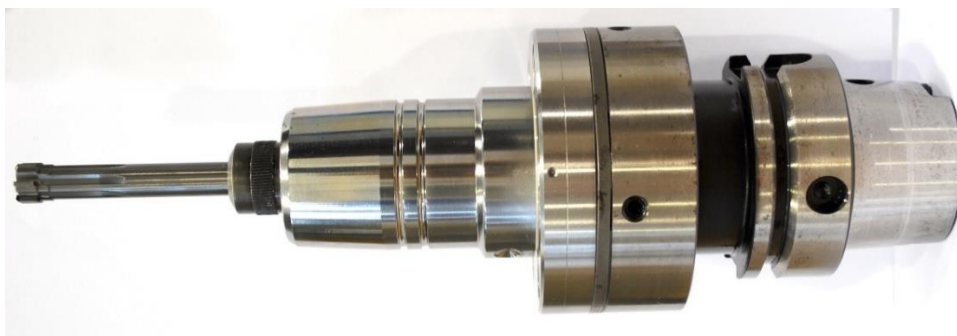
Obr. 17 HAM-FINAL RC s použitím HSK kužele a hydraulického upínače
