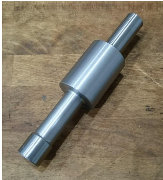
Obr. 34 Průběh výroby nástrojového držáku
