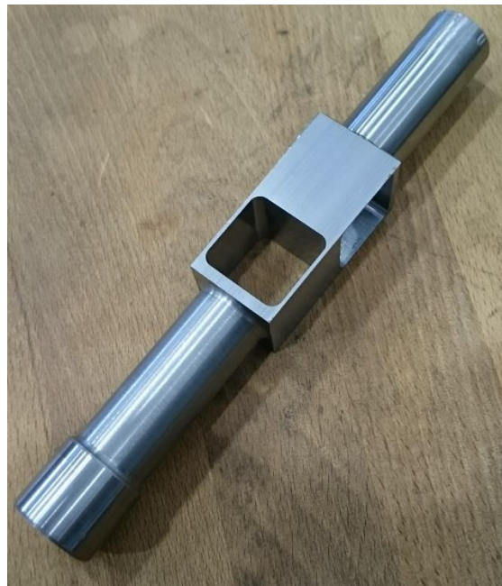
Obr. 35 Průběh výroby nástrojového držáku
