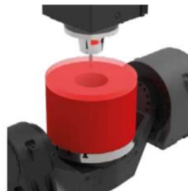
Soustružení čelní a vnitřní
