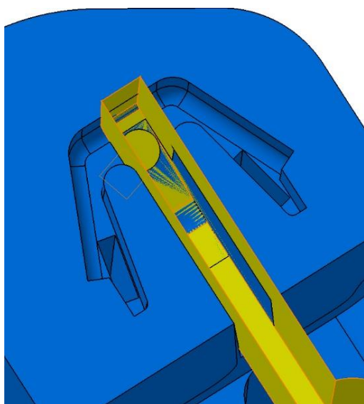
Obrázek 8 - elektroda č.3 - znázornění na tvaru formy
