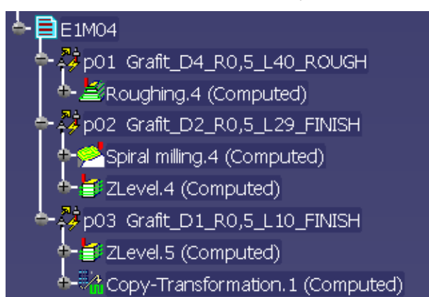
Obrázek 63 - sled cyklů obrábění elektrody č.1
