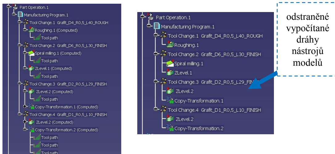
Obrázek 58 - Odstranění vypočítaných drah u cyklů po aplikaci funkce pro tvorbu šablony
