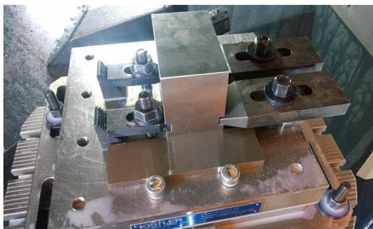
Obr. 27 - Upnutí polotovaru a dynamometr 5080 KISTLER
