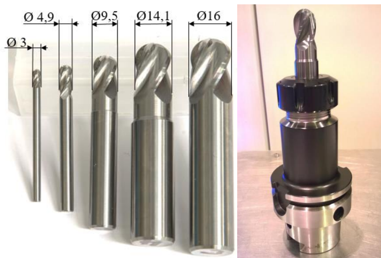
Obr. 25 – Přehled použitých nástrojů a upnutá monolitní fréza D = 14,1 mm
