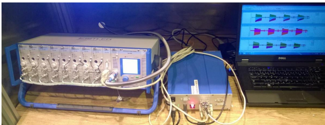
Obr. 30 - Soustava pro měření řezných sil (Zleva: zesilovač signálu, digitalizační karta, SW: Dynoware)
