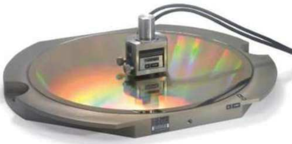
Obr. 28 - Snímač Heidenhain s měřicí deskou [11]
